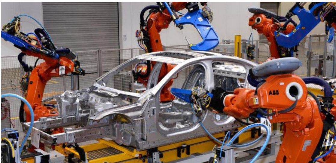
Slika 1.1. Prikaz rada robota u automobilske industriji [1]
