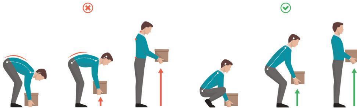
Slika 5.5.1. Prikaz nepravilnog i pravilnog podizanja tereta
