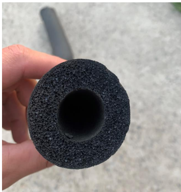
Slika 6.3. Izolacija bakrene cijevi,(Ivan Podravec-31.3.2023.)
