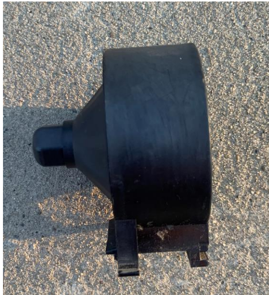
Slika 6.7.3. Plastični utor za vakuumsku cijev, (Ivan Podravec-22.4.2023.)
