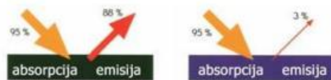
Slika 4.1. Klasična i selektivna površina (preuzeto s interneta)
