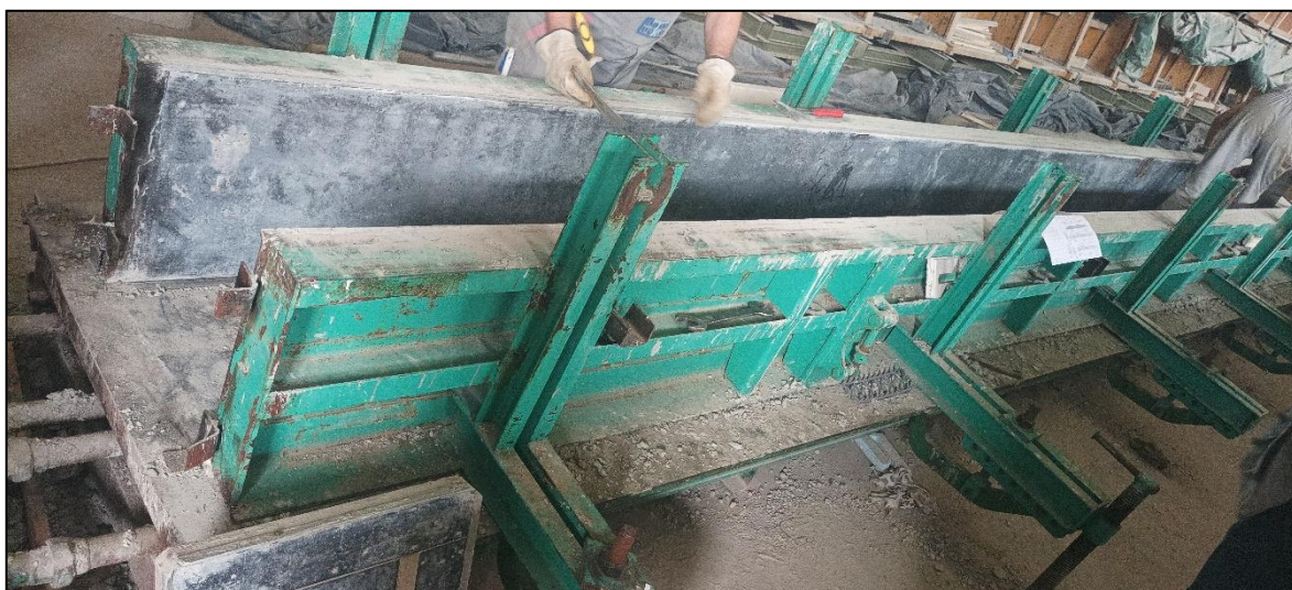
Slika 22: Oplata grede Beton Lučko d.o.o. (izvor: osobna arhiva)
