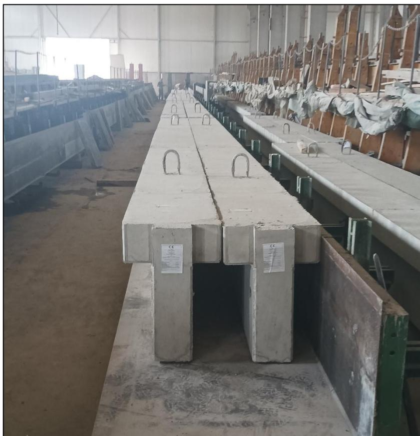
**Slika 7: Montažna Ab greda T poprečnog presjeka (izvor: osobna arhiva)**
