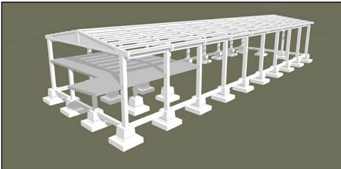
Slika 5: Betonska hala od predgotovljenih elemenata-3D vizualizacija (izvor: <https://www.stanoinvest.hr/project/armirano-betonske-montazne-konstrukcije-hala-trnovec-bartolovecki/> , pregledano 20.10.2022.)
