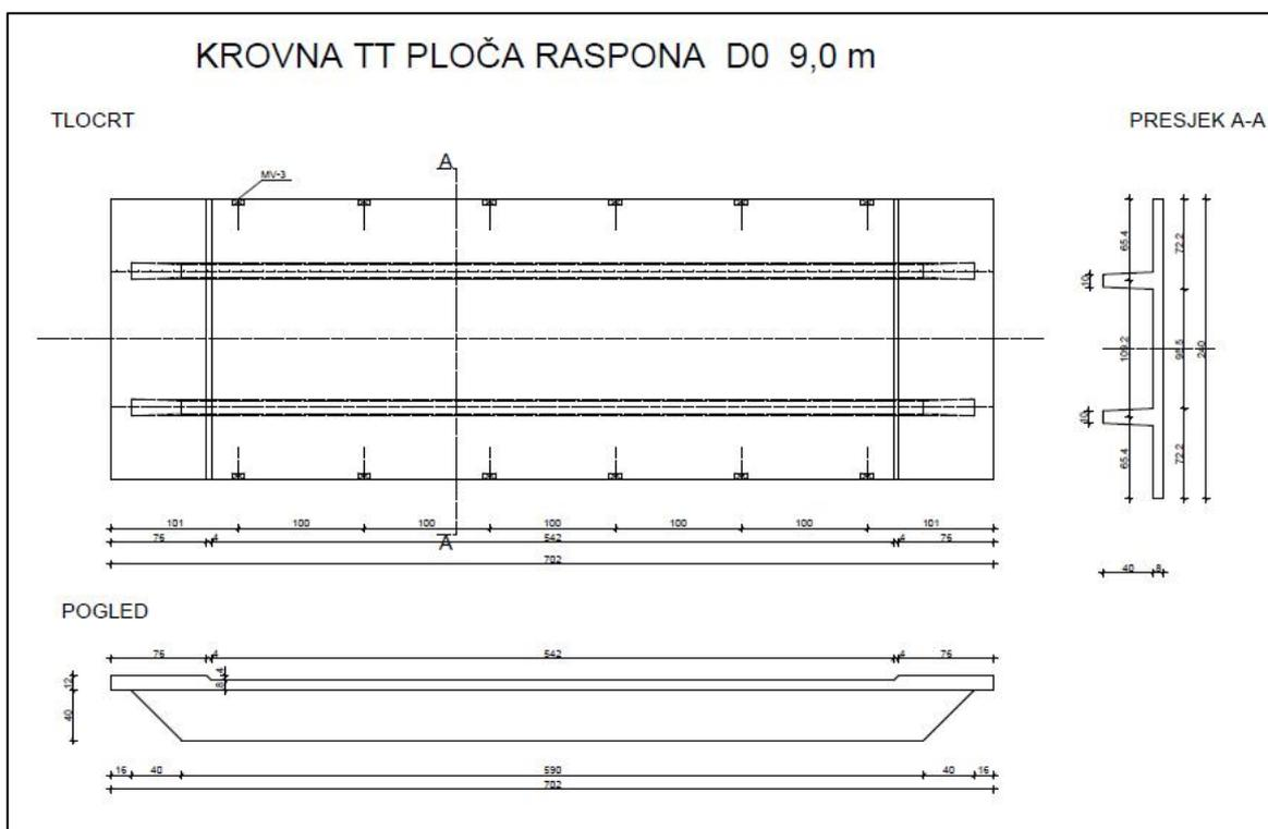
**Slika 9: Plan oplata krovne TT ploče (izvor: <https://www.betonlucko.hr/files/sistemi-gradjenja/montazni-sistemi/montazni-sistemi-gradjenja.pdf>)**
