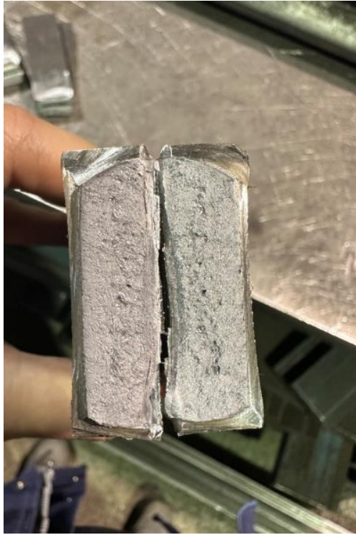
Slika 5.13.: Presjek zavarenog uzorka nakon prijeloma [34]
