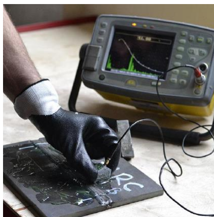
Slika 3.4. Ultrazvučno ispitivanje zavarenog spoja [15]
