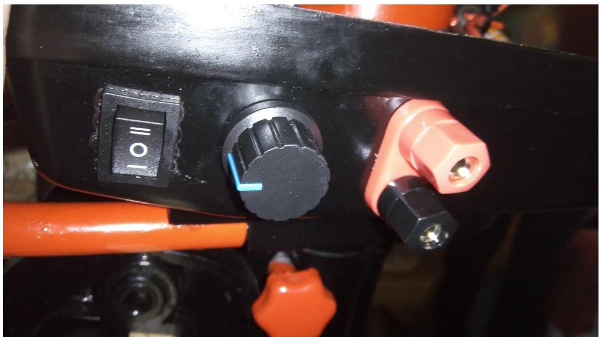
Slika 4.18. Prekidač za biranje smjera kretanja, potenciometar i priključak vanjskog akumulatora
