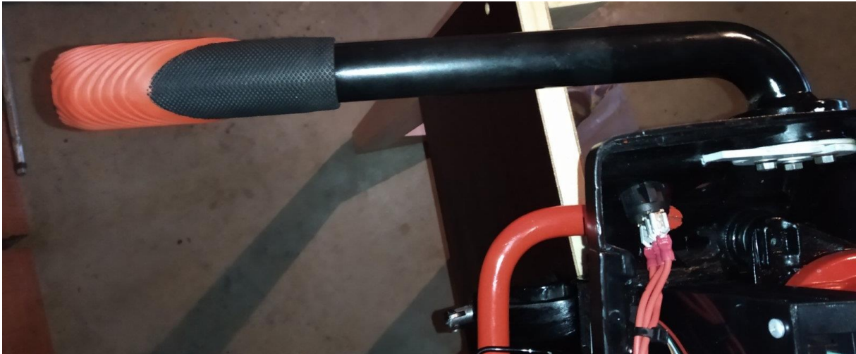
Slika 4.13. Prikaz nove ručke za upravljanje smjerom kretanja
