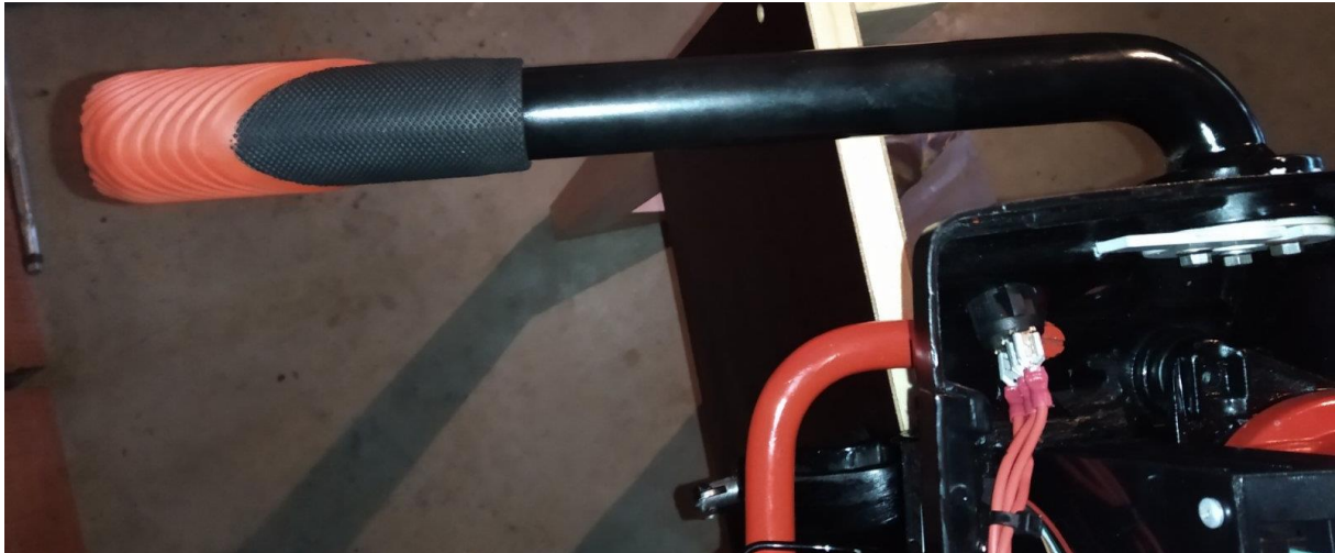
Slika 4.13. Prikaz nove ručke za upravljanje smjerom kretanja
