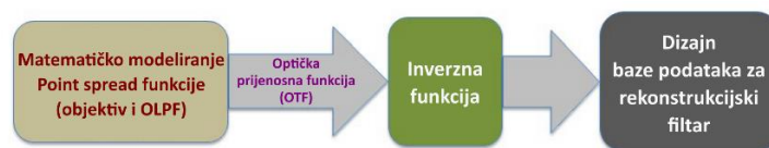
Slika 5.23 - Proces za izradu baze podataka za korekciju difrakcije [8]
