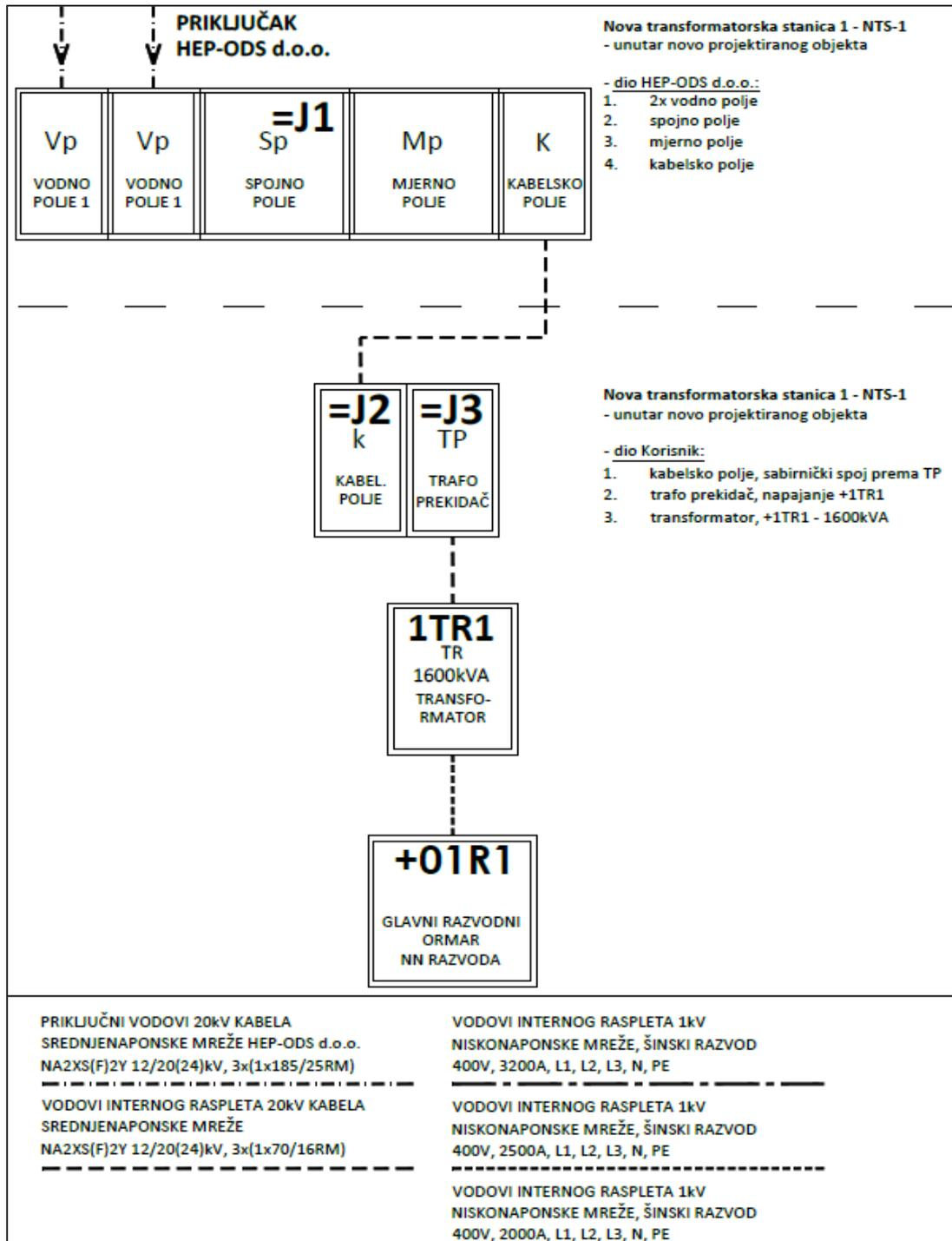
Slika 9. Blok-shema SN instalacije trafostanice [8]
