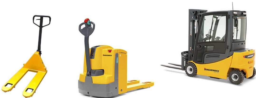
Slika 30: Ručni, motorno-ručni i motorni viličari
