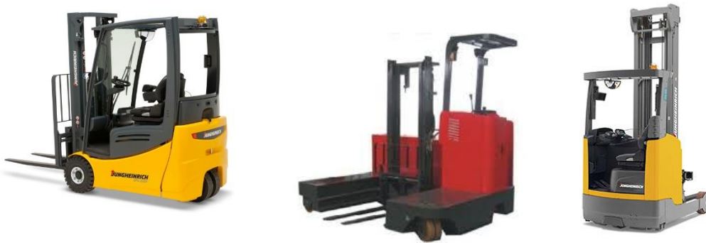
Slika 31: Čeoni, bočni i regalni viličari
