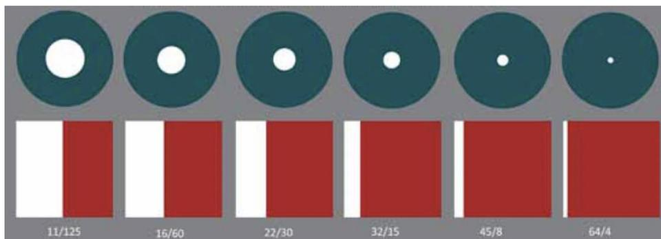
Slika 9.3.1. Prikaz smanjivanja otvora blende, a produljenje brzine zatvarača
