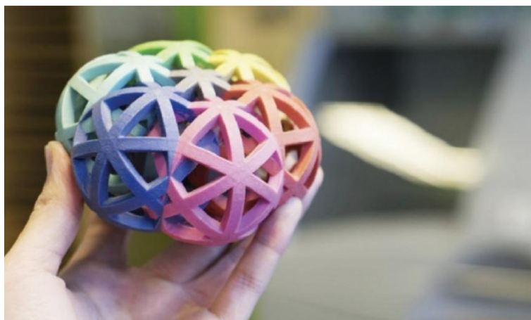
Slika 2.11. Model ispisan u boji upotrebom binder jetting tehnologije 3D ispisa
