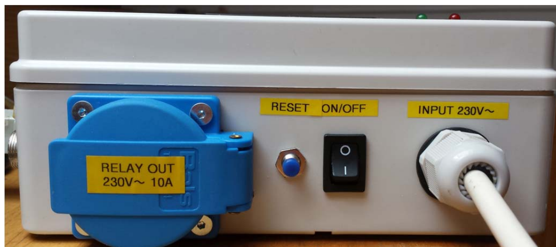
Slika 13: Upravljačka jedinica sustava upravljanja – stražnja strana
