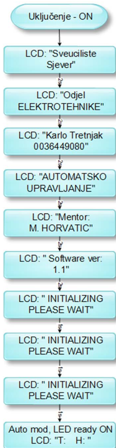
Slika 19: Dijagram toka ispisa na LCD zaslonu nakon uključenja
