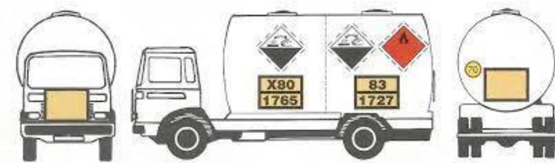
Slika 5: Primjer postavljanja listice na vozilu [10]
