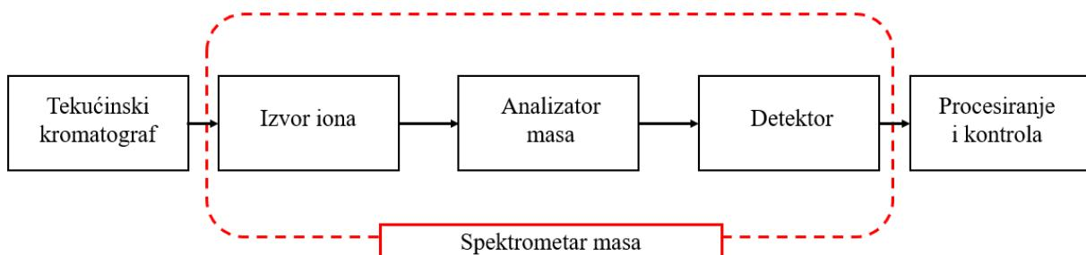
Slika 16. Blok shema spregnutog sustava LC-MS, izvor: prilagođeno iz [17]
