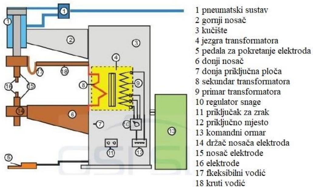
Slika 22. Shema stroja za točkasto zavarivanje [12]
