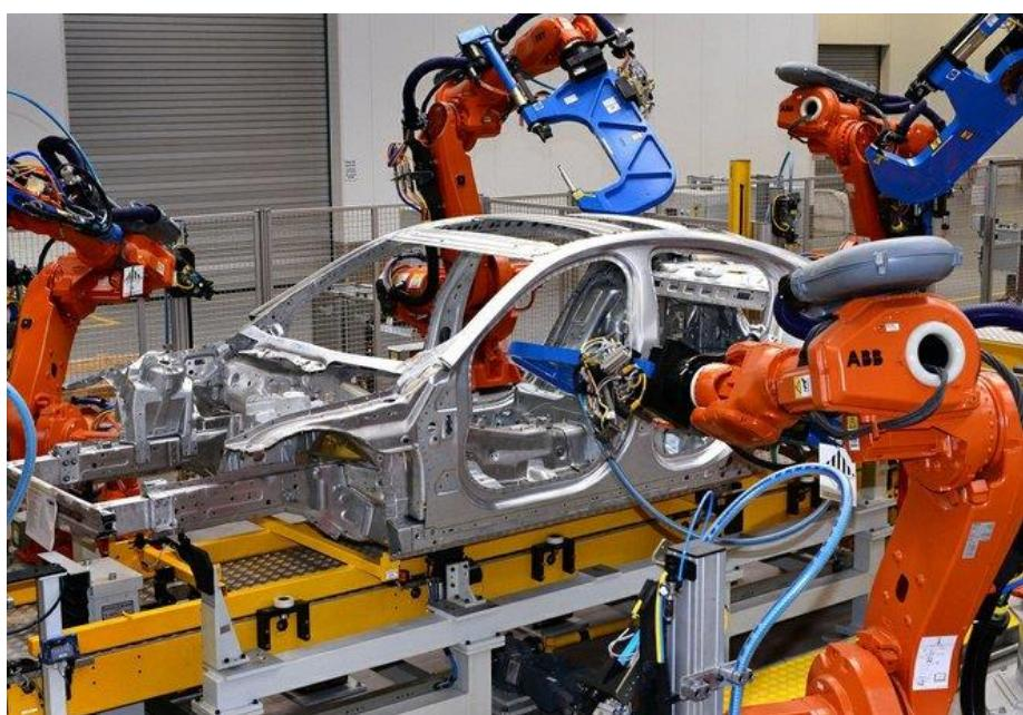
Slika 26. Automatiziran postupak točkastog zavarivanja u automobilskoj industriji [27]
