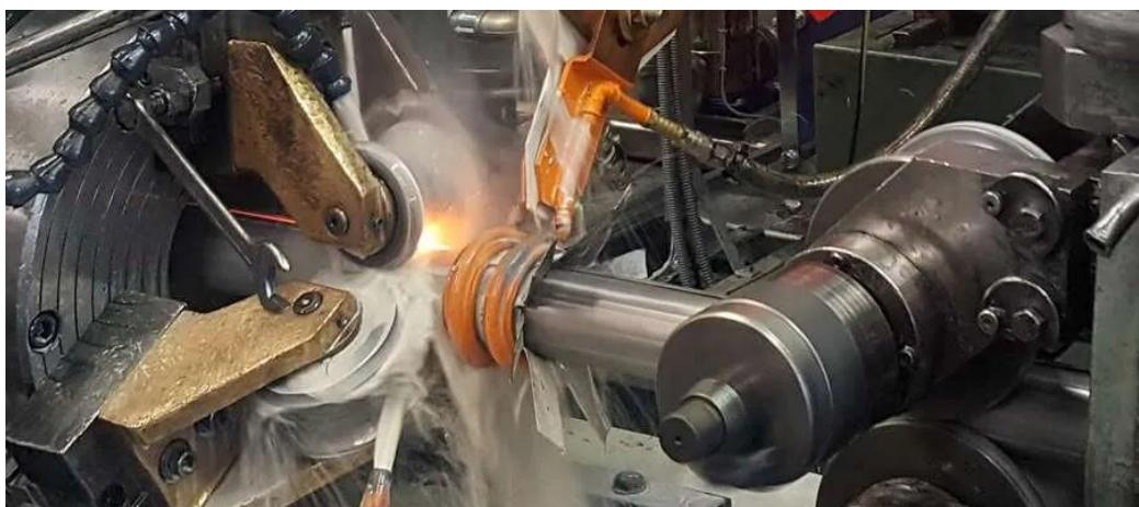
Slika 15. Visoko frekventno induksijsko zavarivanje [20]
