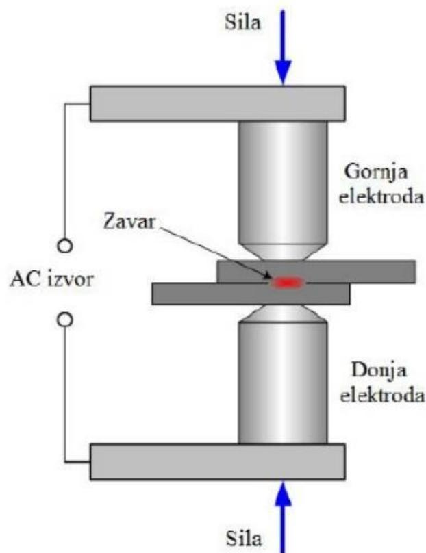
Slika 8. Shematski prikaz elektrootpornog točkastog zavarivanja [13]
