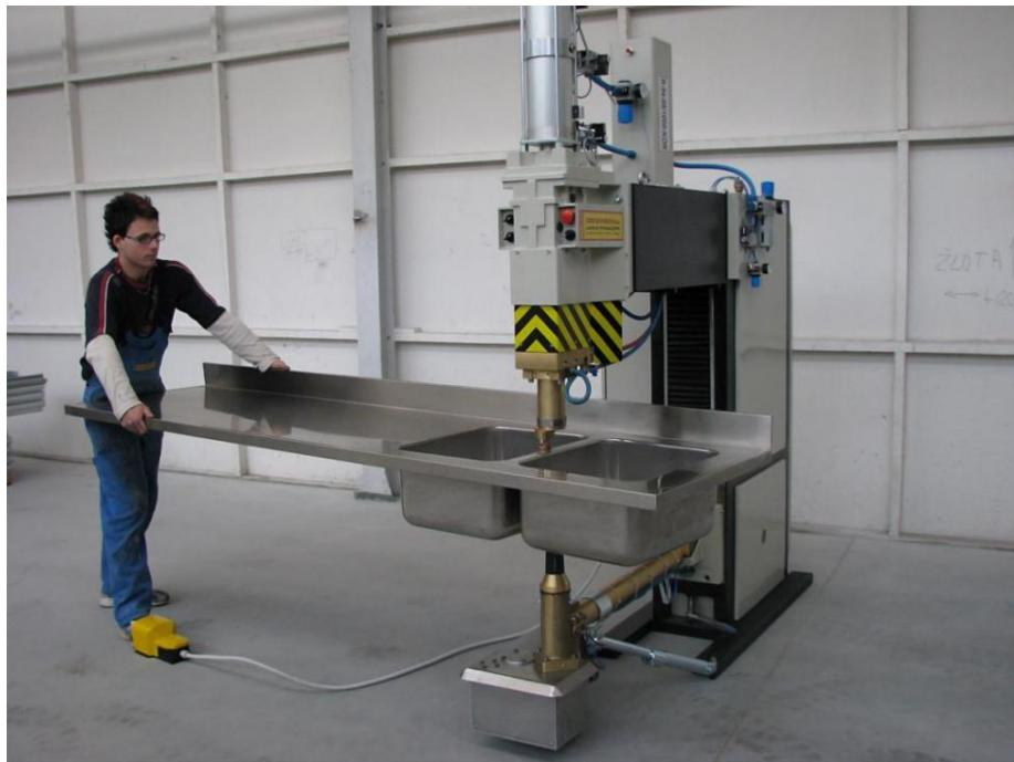
Slika 27. Robotizirano točkasto zavarivanje [28]
