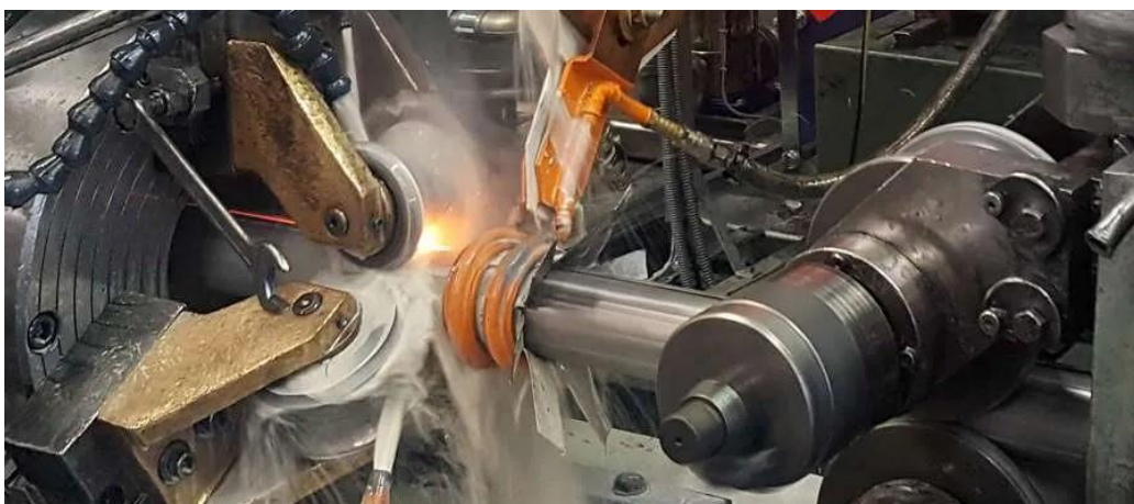
Slika 15. Visoko frekventno induksijsko zavarivanje [20]
