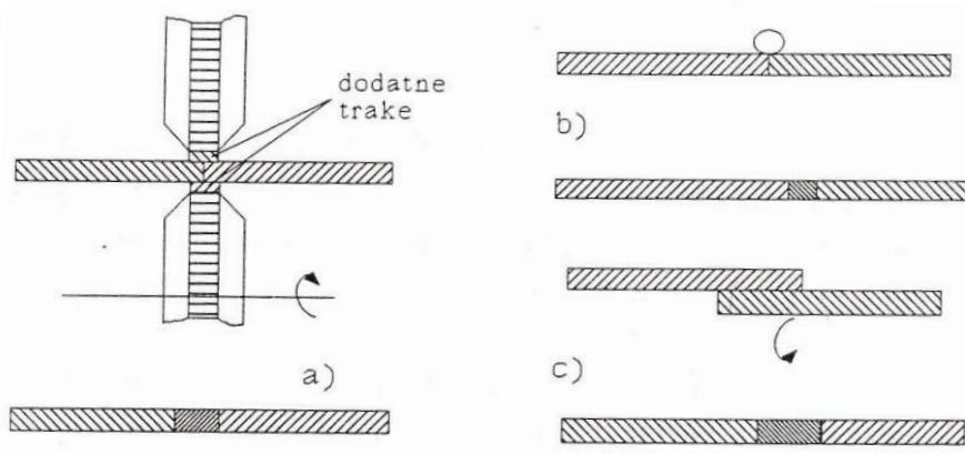
Slika 11. Modifikacija šavnog elektrootponog zavarivanja [3]
