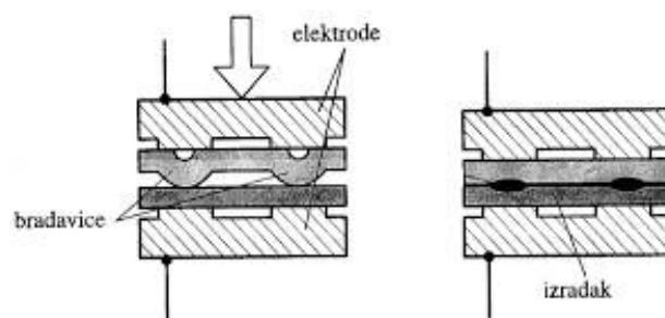
Slika 9. Shematski prikaz elektrootpornog bradavičastog zavarivanja [14]
