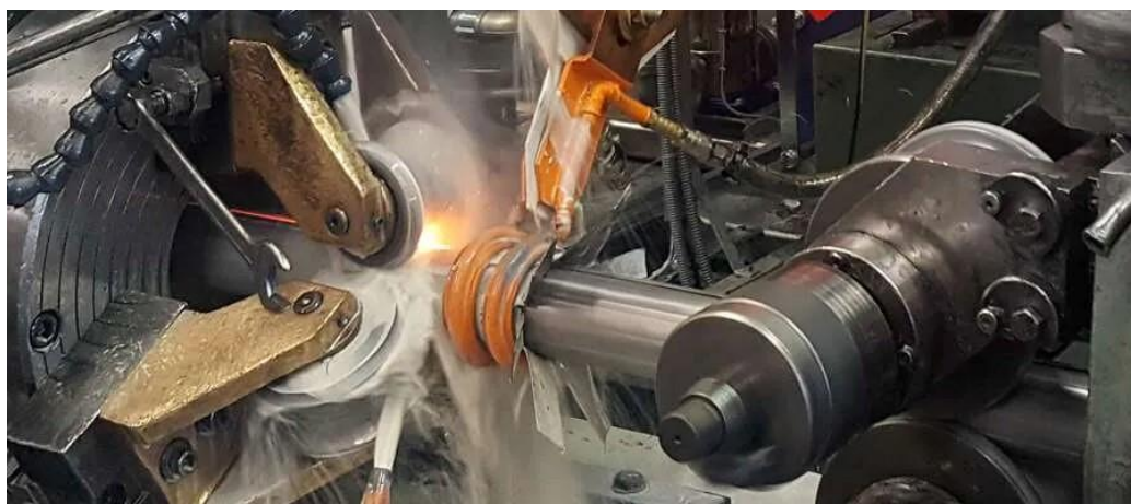
Slika 15. Visoko frekventno induksijsko zavarivanje [20]
