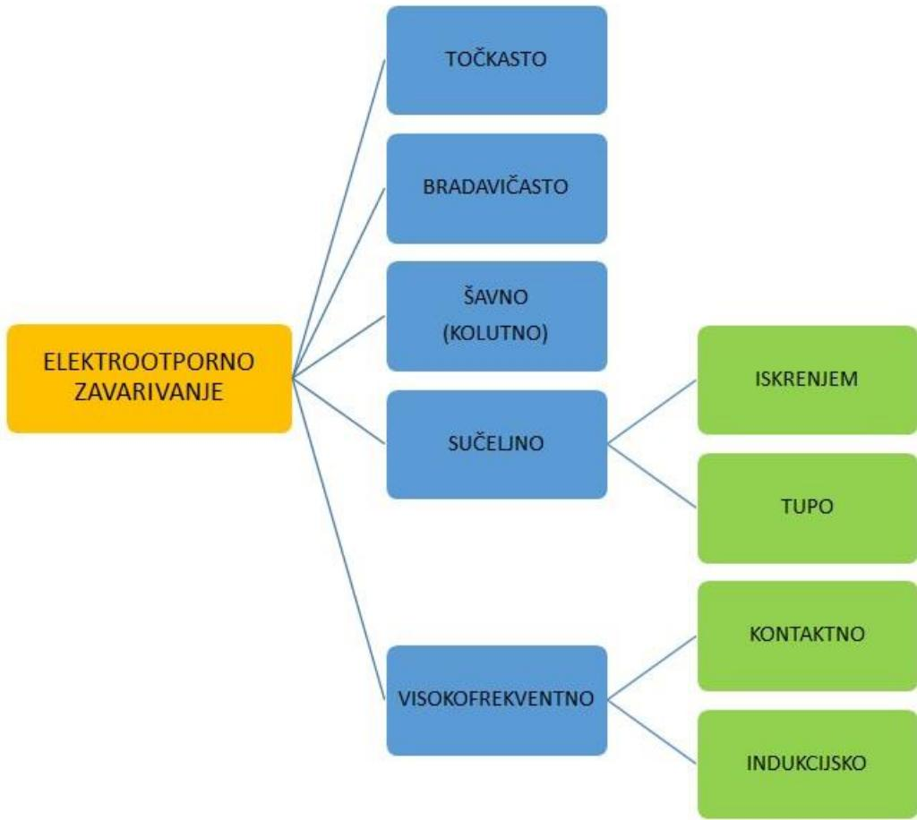
Slika 7. Vrste elektrodepornog zavarivanja [10]
