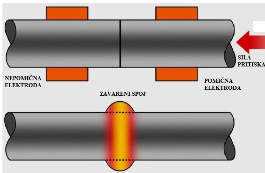
Slika 12. Prikaz sučeljnog zavarivanja pritiskom [15]
