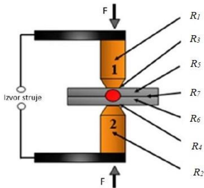
Slika 21. Shema otpora elektrootpornog točkastog zavarivanja [23]
