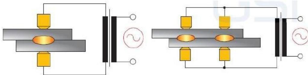
Slika 17. Obostrano i paralelno točkasto zavarivanje [4]
