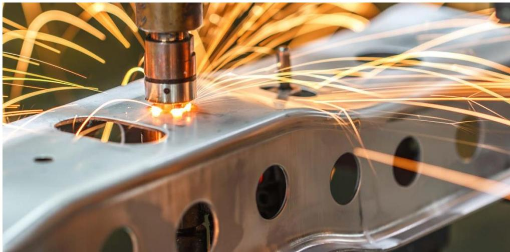
Slika 16. Točkasto elektrootporno zavarivanje [21]
