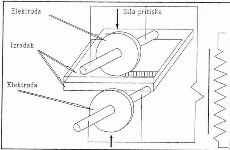
Slika 10. Shematski prikaz elektrootpornog šavnog zavarivanja [3]
