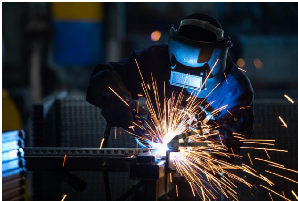
Slika 2. MIG zavarivanje plinskim lukom [6]
