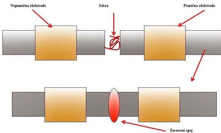
Slika 13. Prikaz sučeljnog elektrootpornog zavarivanje iskrenjem [16]
