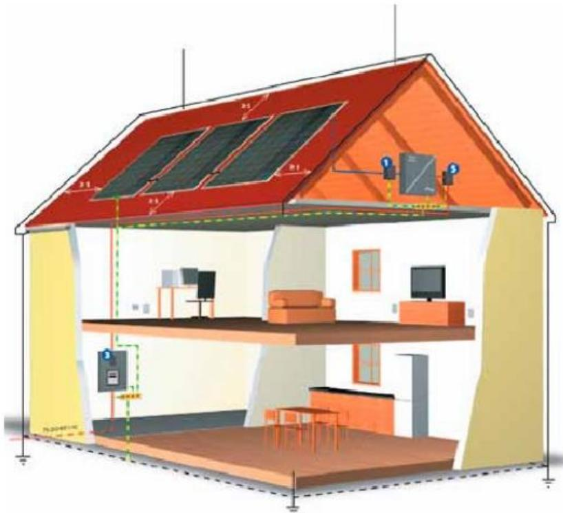
Slika 19. Gromobranska instalacija građevine [5].
