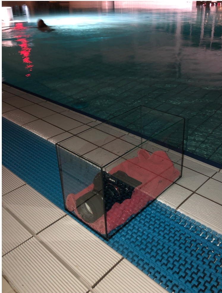
Slika 21 Akvarij sa kamerom (snimanje pod vodom)
