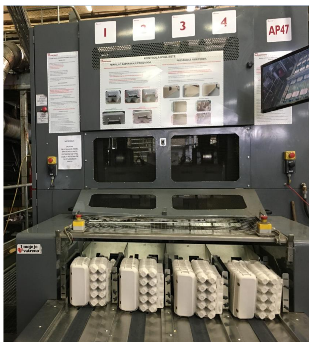
Slika 10. Polugotova prešana kartonska ambalaža u Hartmannu
