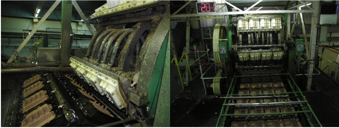
Slika 9. Dotoci pulpe u strojno korito u Hartmannu
