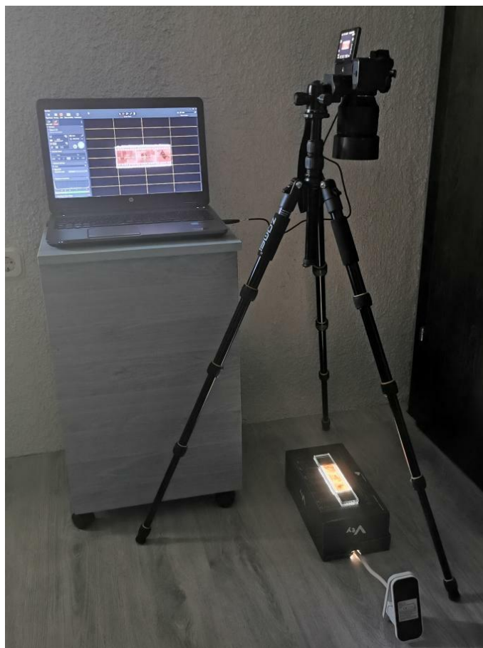
Slika 3. Primjer improvizirane konfiguracije alata za razvijanje filma Tether tehnikom – autorski primjer
