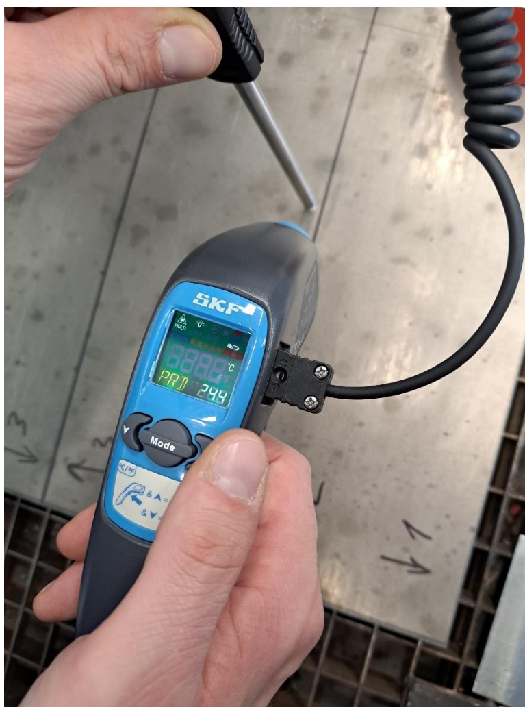
Slika 7.8 Temperaturu materijala prije prvog reza (fotografirano na Sveučilištu Sjever)
