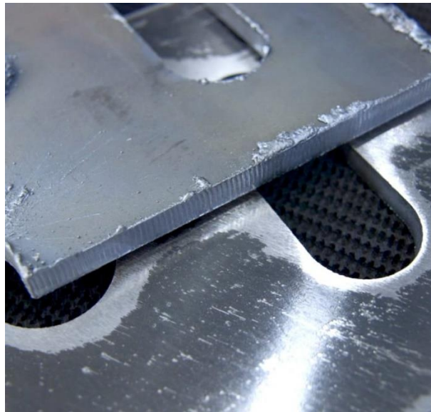
Slika 4.2 Izrezani segmenti prije i nakon uklanjanja troske [17]
