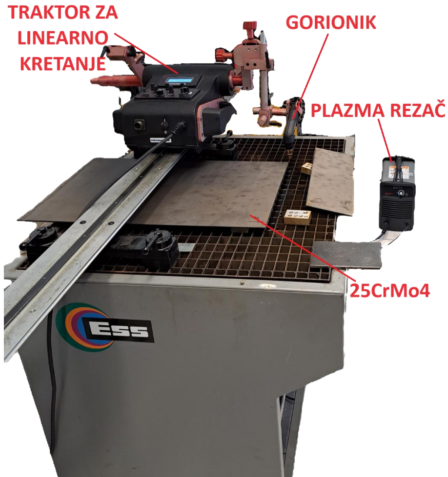
Slika 7.2 Oprema za provođenje rezanja (fotografirano na Sveučilištu Sjever)
