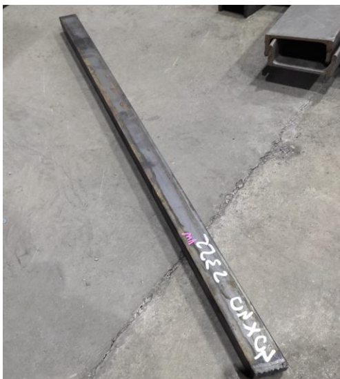
Slika 5.25 Sirovac 1000x40x40 mm (osobne slike)
