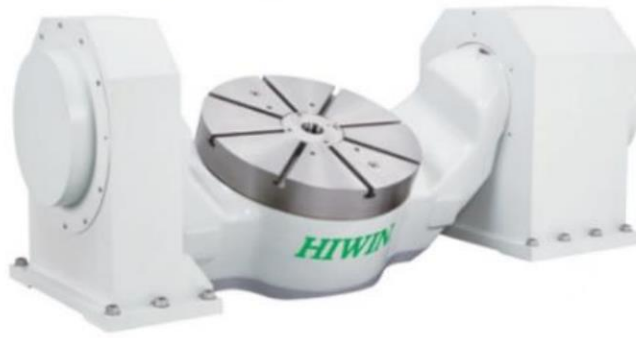
Slika 3.8 Dvostruko direktno pogonjeni okretno nagibni stol [26]
