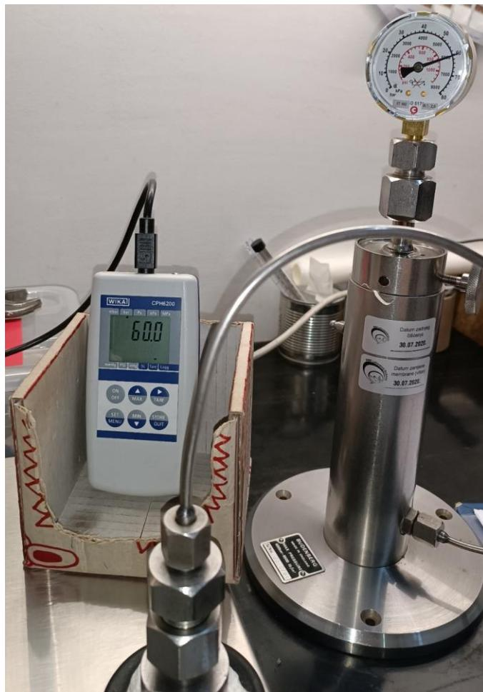
Slika 16 Umjeravanje mjerila u mjernom području 0/80 bar – prikaz etalona i mjerila
