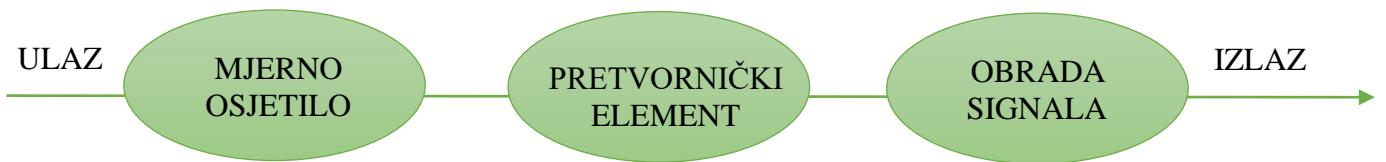
Slika 9 Struktura mjernog pretvornika
