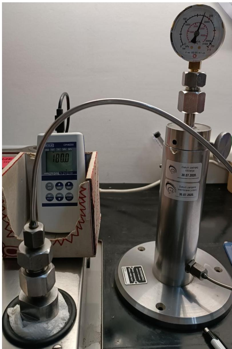
Slika 18 Umjeravanje mjerila u mjernom području 0/315 bar
