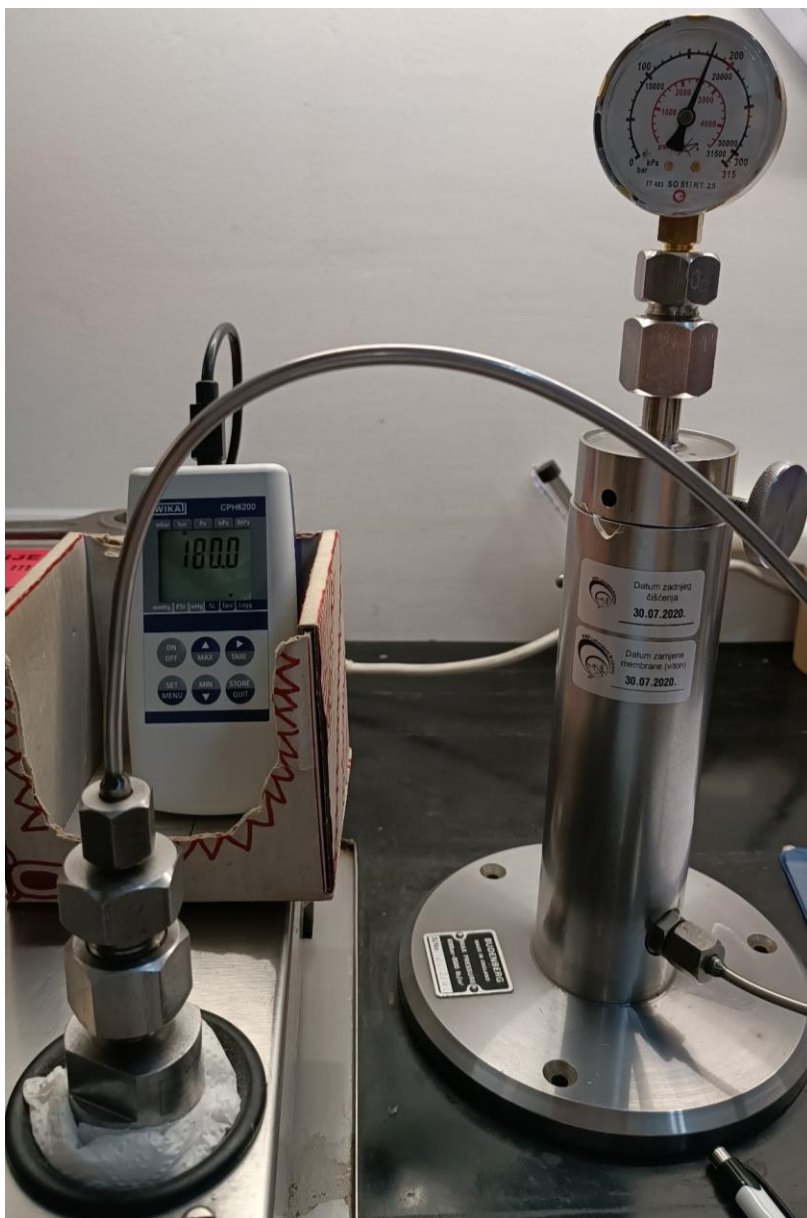
Slika 18 Umjeravanje mjerila u mjernom području 0/315 bar
