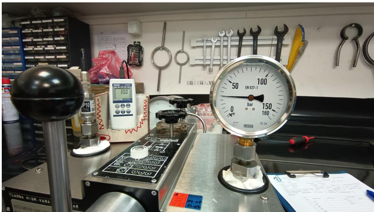
Slika 14 Umjeravanje mjerila u mjernom području 0/160 bar
