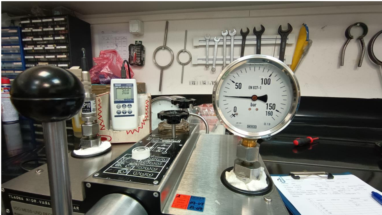
Slika 14 Umjeravanje mjerila u mjernom području 0/160 bar
