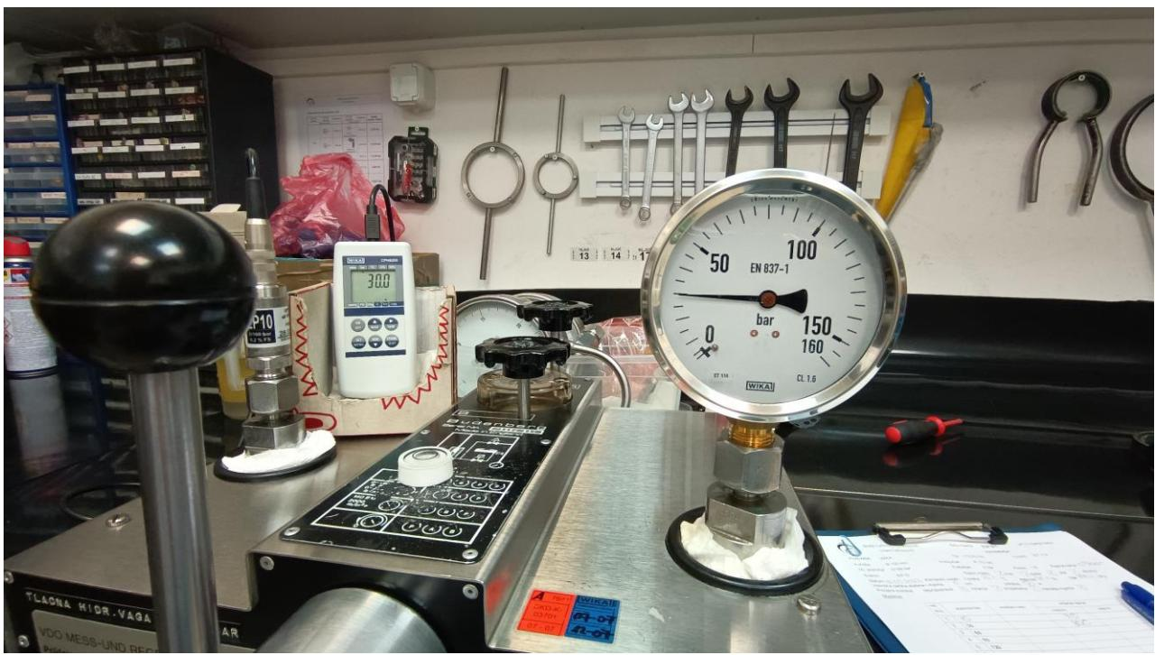
Slika 14 Umjeravanje mjerila u mjernom području 0/160 bar
