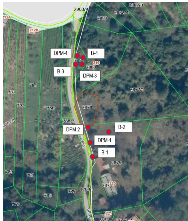
Slika.21. položaj izvedenih bušotina na protokliznoj cesti te pribriježnoj strani ceste
