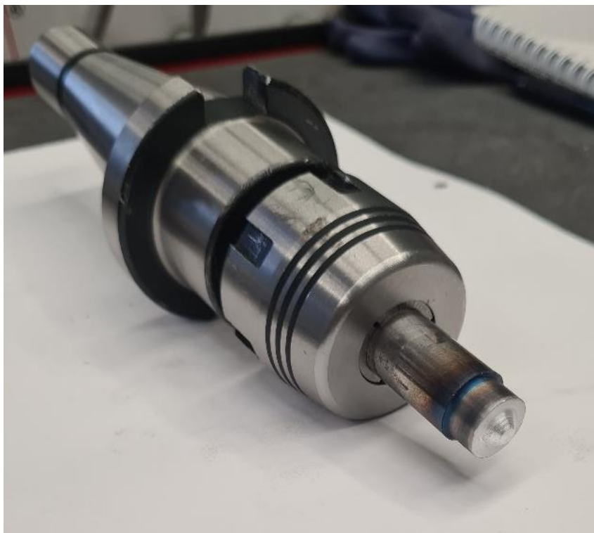
Slika 4.13 FSW alat poslije zavarivanja
