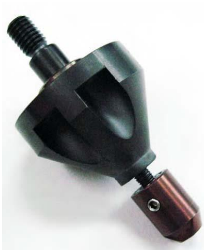
Slika 3.13 Primjer alata u obliku špule [13]
