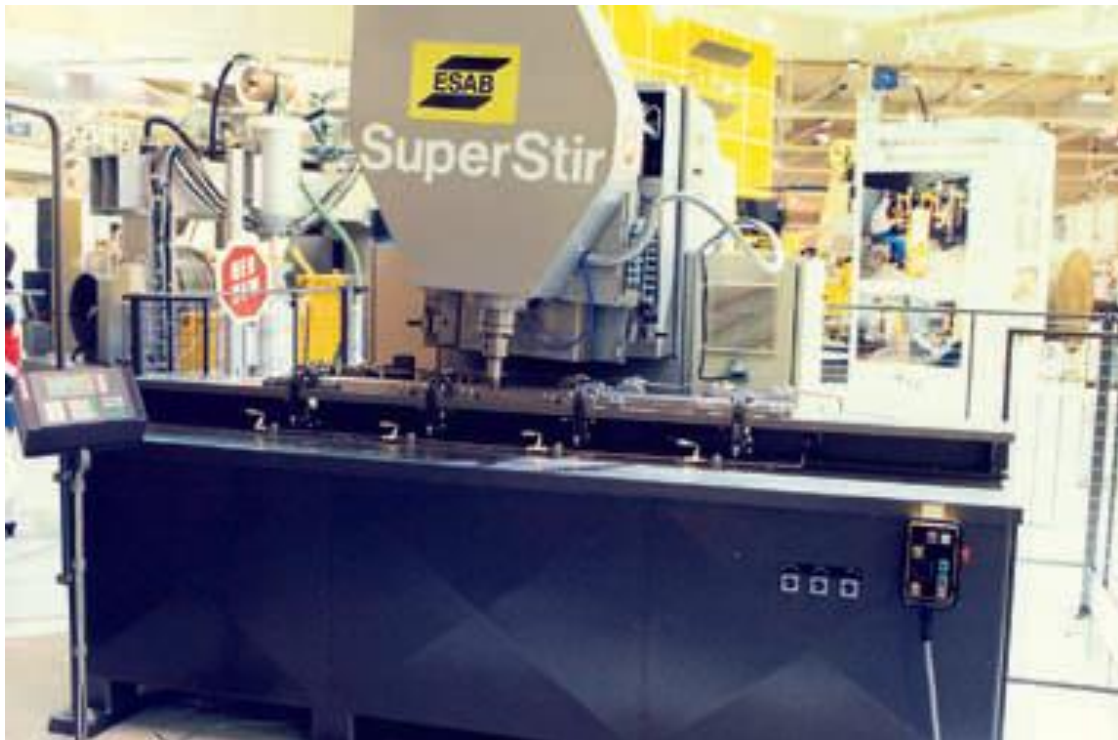
Slika 3.30 SuperStir™ #1 – prvi uređaj za zavarivanje trenjem rotirajućim alatom predstavljen na 1997. na sajmu Schweissen & Schneiden [20]
