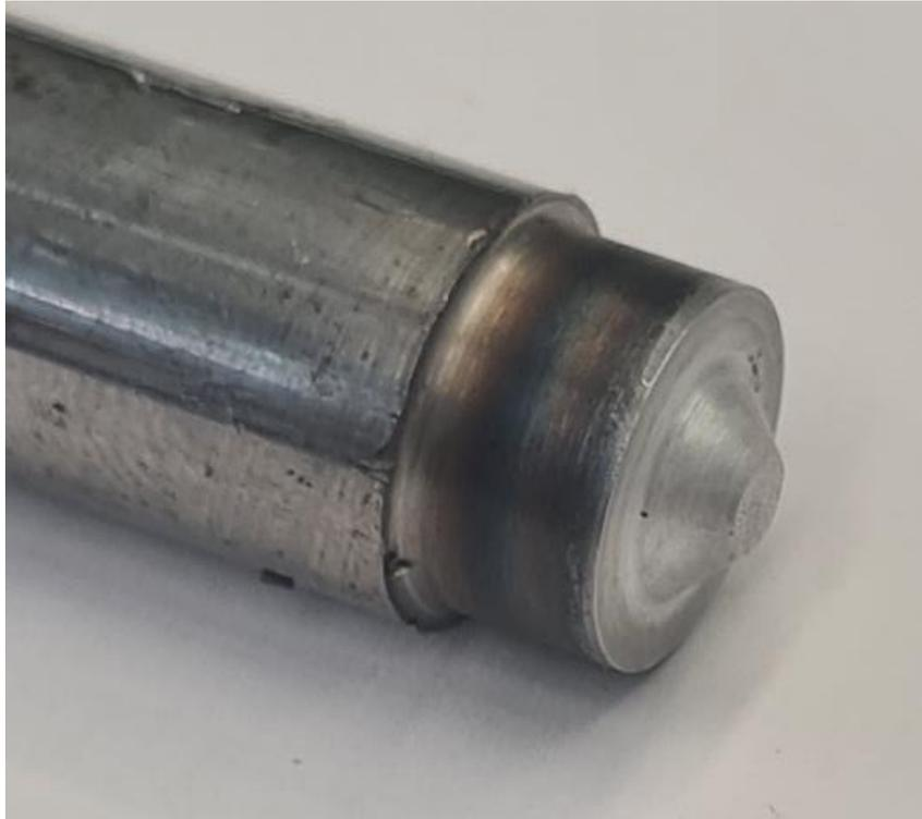
*Slika 4.12 FSW alat prije zavarivanja*
