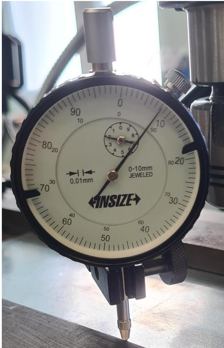
*Slika 4.2 Mjerni sat - komparator*
