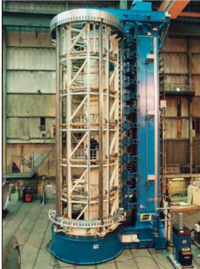
Slika 3.31 Spremnik za raketno gorivo izrađen FSW tehnologijom [20]
