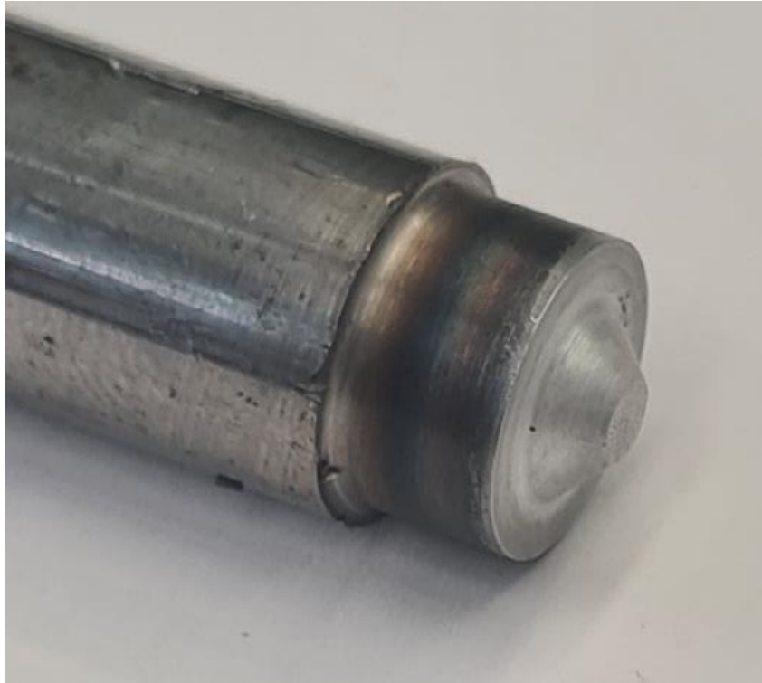
Slika 4.12 FSW alat prije zavarivanja
