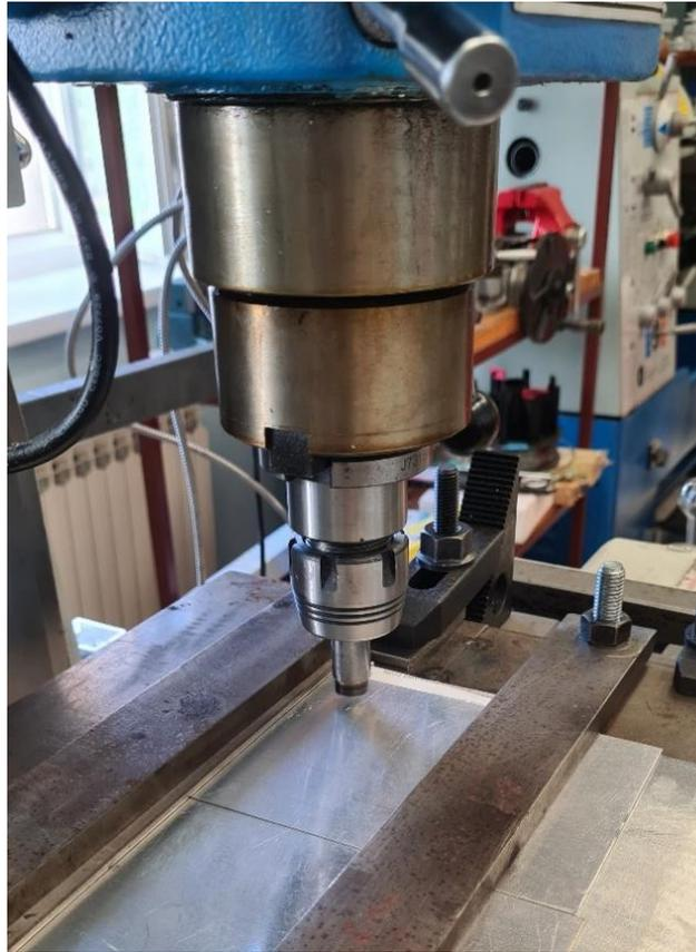
*Slika 4.10 Pozicioniranje alata iznad radnog komada*
