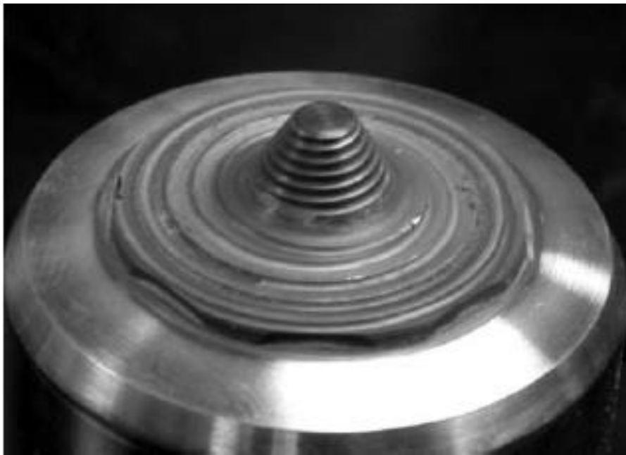
Slika 3.9 Konveksno čelo alata s navojima (utorima) [13]
