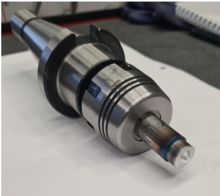
*Slika 4.13 FSW alat poslije zavarivanja*
