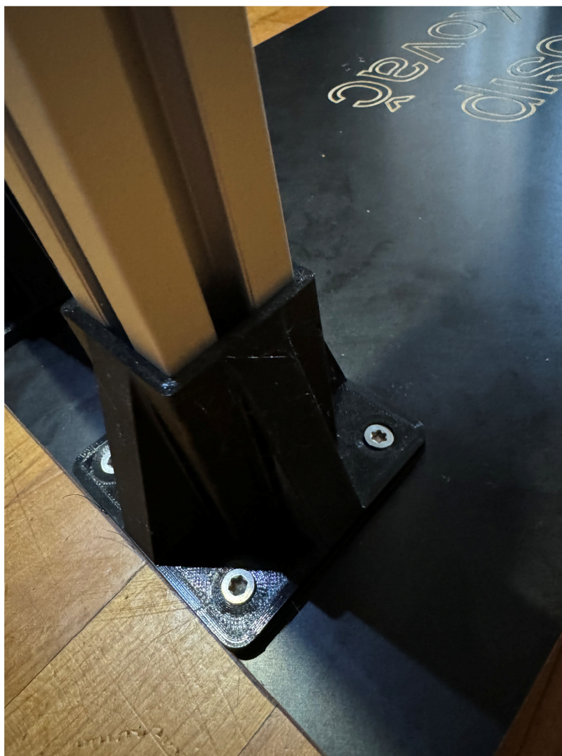
Slika 23 Prikaz učvršćenja aluminijske konstrukcije za drvenu podlogu
