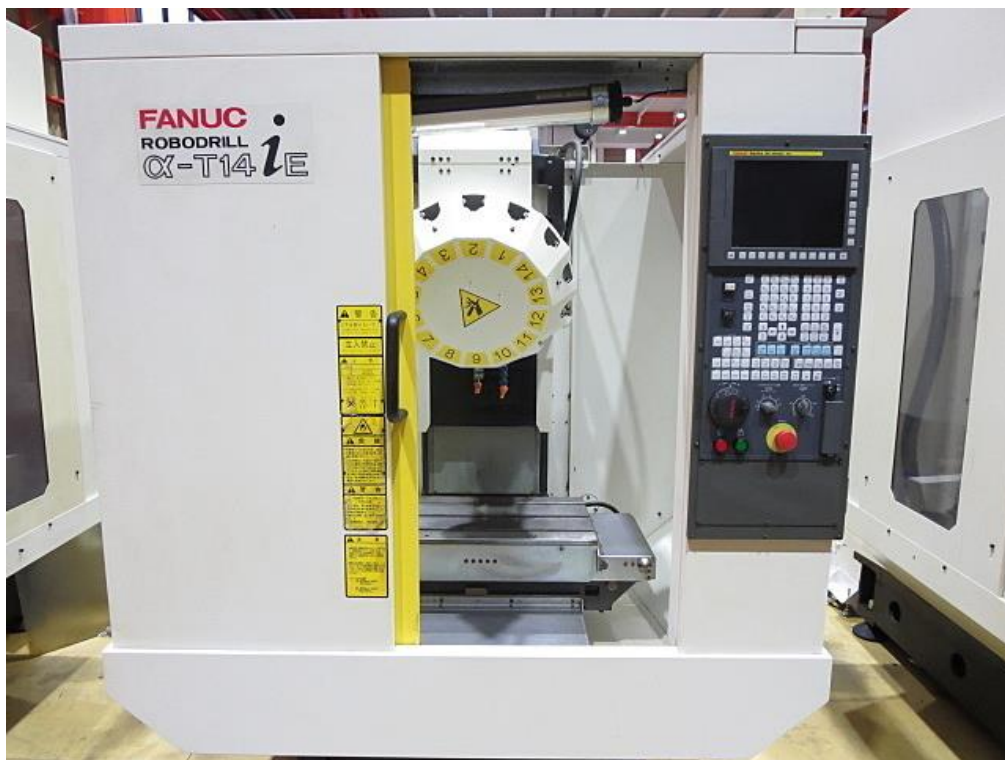
Slika 5.2. Prikaz ALPHA T-14iE CNC stroja [23]
