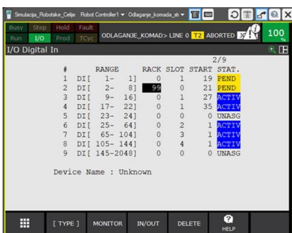
Slika 7.2.1. Postavljanje ulaznih signala
