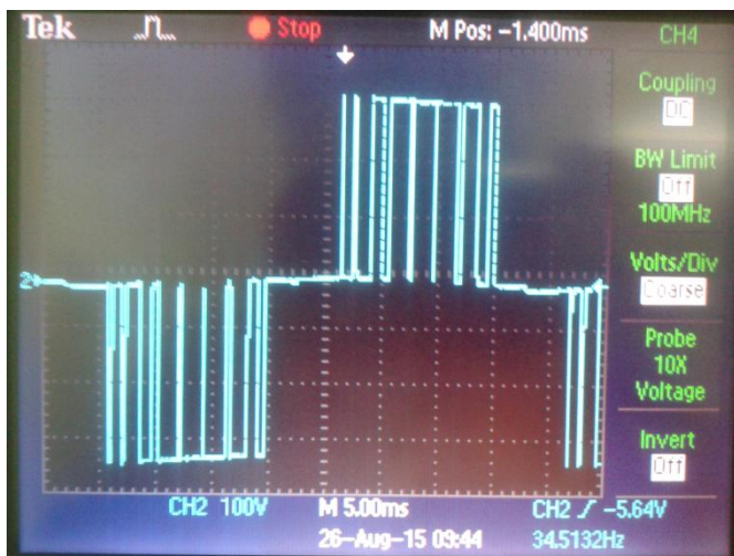
Slika 9.1 Valni oblik napona na izlazu iz pretvarača pri frekvenciji od 35 Hz
