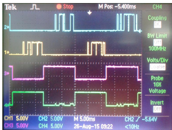
Slika 9.9 Valni oblici napona na gate driveru za svaki IGBT pri frekvenciji od 65Hz
