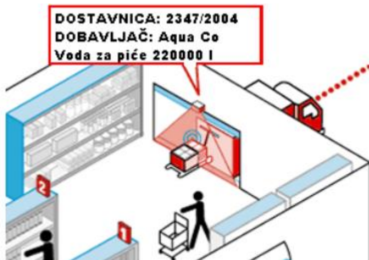
Slika 28: Korištenje RFID tehnologije u skladištu
