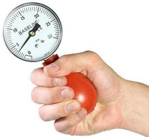
Slika 6.2.1: Pneumatski dinamometar
