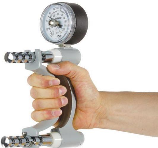
Slika 6.1.1: Jamar hidraulični dinamometar
