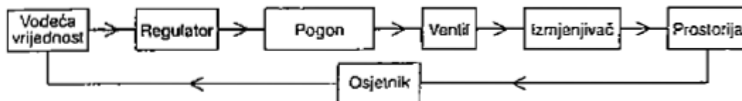
Slika 3.1 Osnovni elementi regulacijskog kruga [15]
