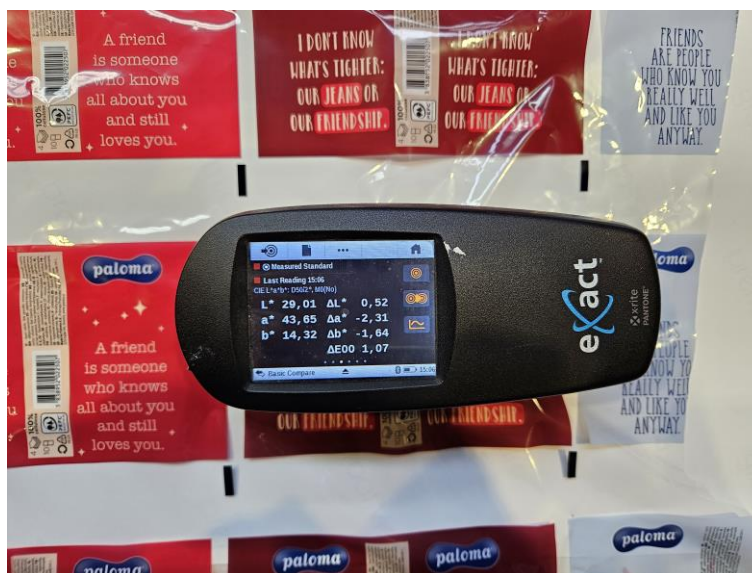
Slika 23 Kontrola boja s pomoću Xrite spektrofotometra (Izvor autora)
