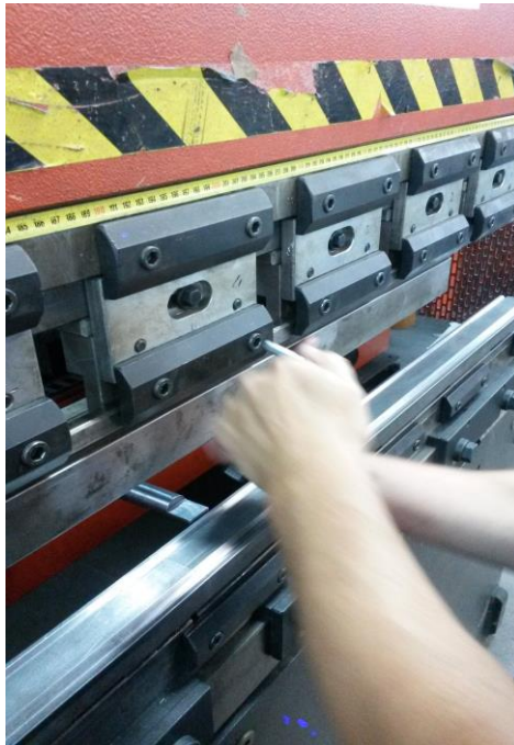
Slika 7.1 Otpuštanje vijaka imbus ključem
