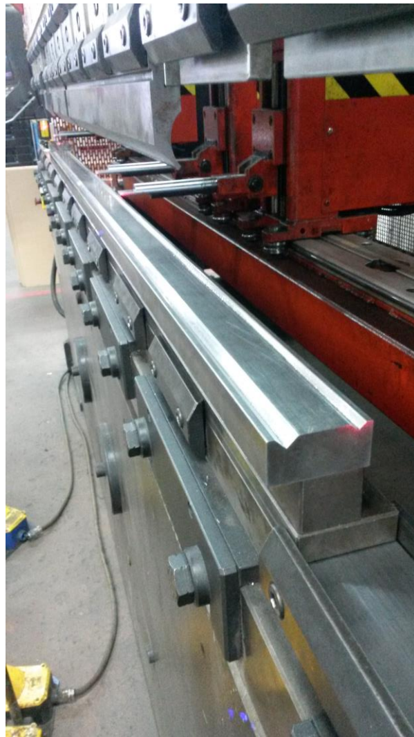
Slika 7.3 Prikaz matrice i alata za savijanje
