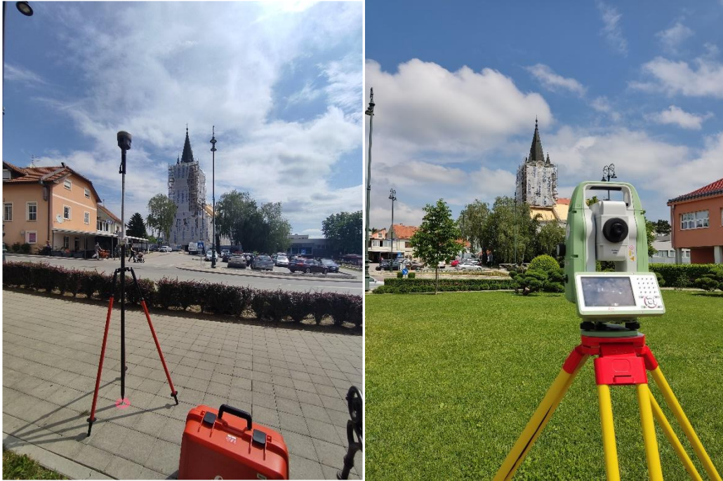
Slika 18. Signalizacija točkaka u Svetom Ivanu Zelini pomoću prizme i tronošca
