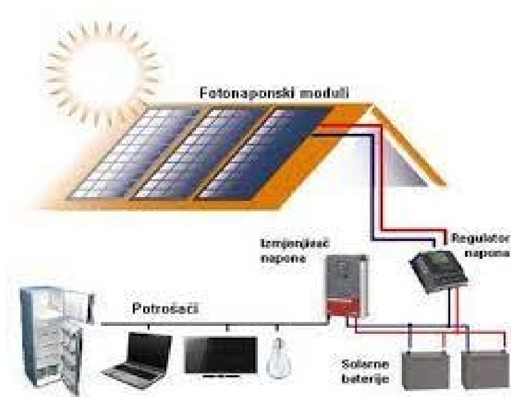
Slika 13. Samostalni fotonaponski sustav [10]
