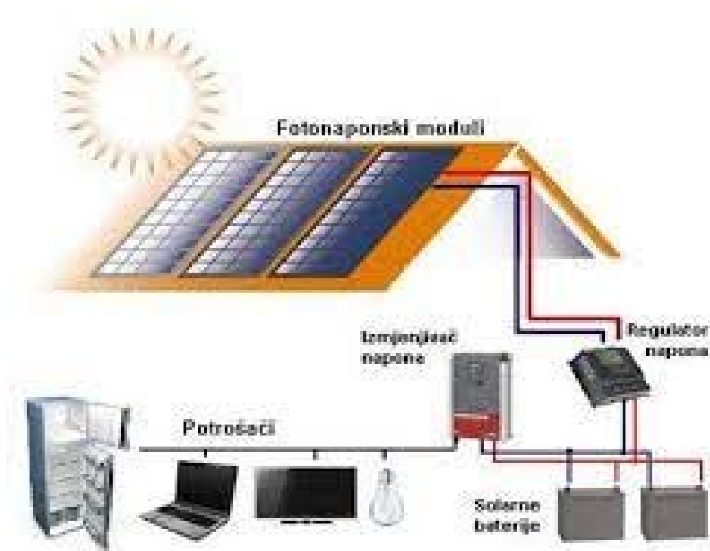
Slika 13. Samostalni fotonaponski sustav [10]
