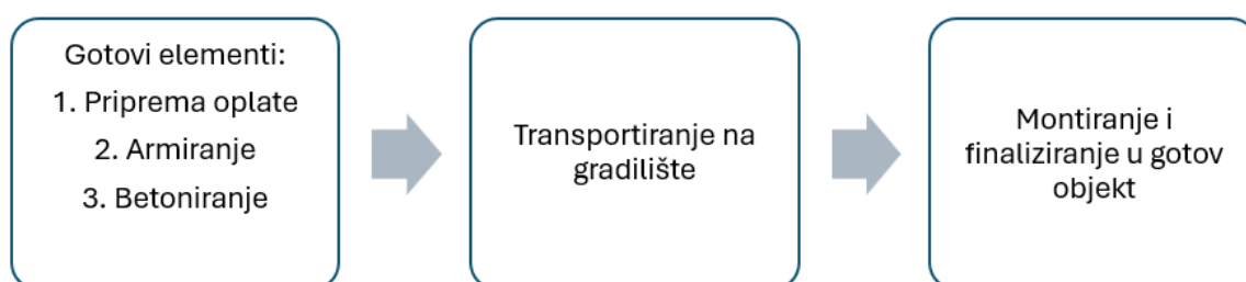
Slika 1.1. Shematski prikaz proizvodnje elemenata u stacionarnom pogonu
