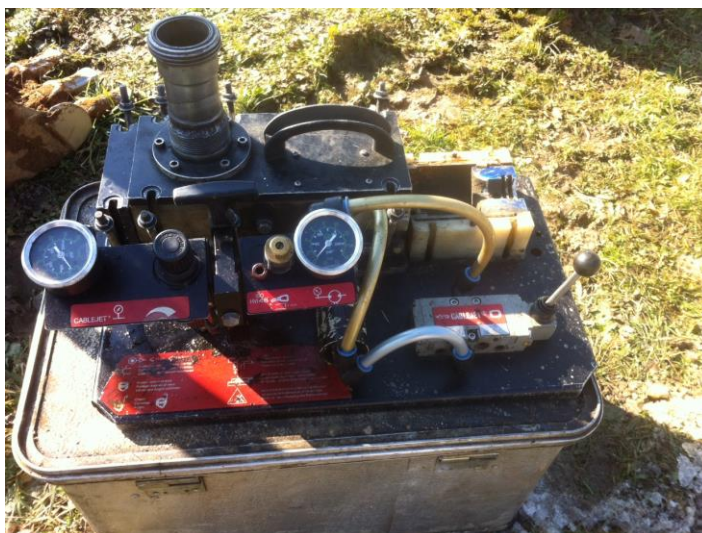
Slika 3.9. Aparat za upuhivanje optike, Cablejet (izvor: autor)
