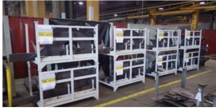
Slika 20. Specijalne palete za dijelove postolja dizalice za kamione (LKW ), Palfinger d.o.o., Delnice
