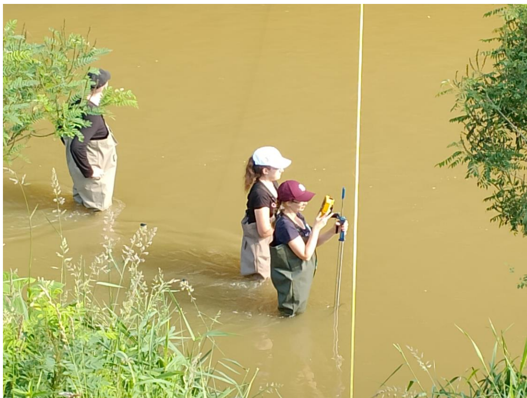
Slika 4.17. Mjerenje ADV-om – poprečni profil 1 [5]
