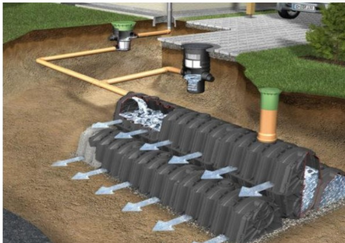
Slika 18. Presijek upojnog tunela
