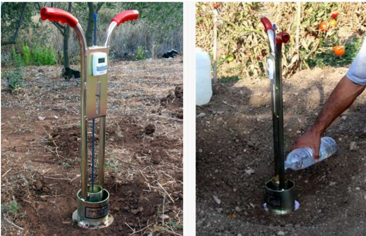
Slika 4. Mjerenje infiltracije infiltrometrom s dvostrukim cilindrom
