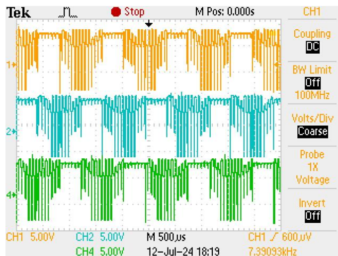
Slika 5.10 Valni oblici napona faza pri 1.7A, 7030 okr/min
