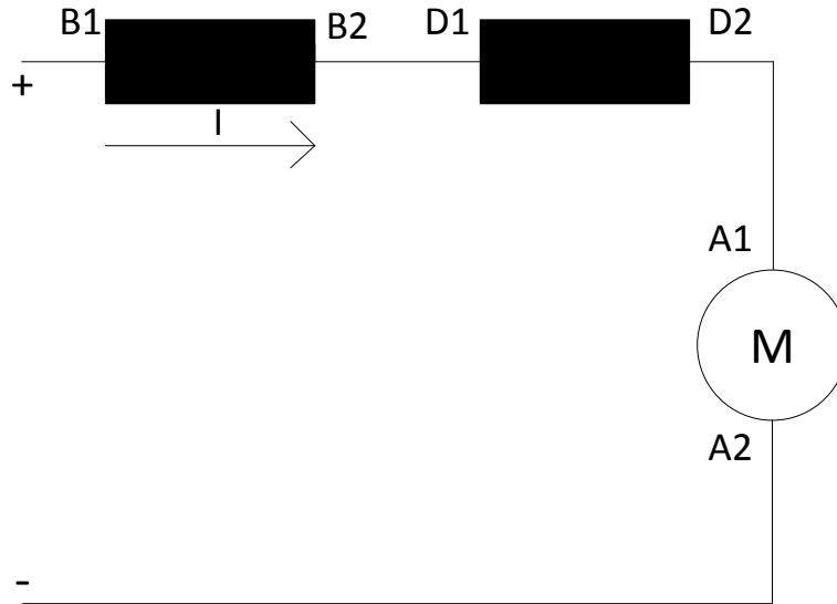
Slika 2.6 Shema istosmjernog motora sa serijskom uzbudom
