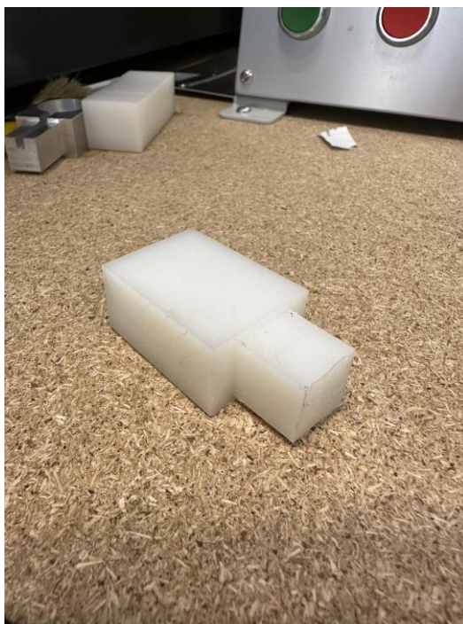
Slika 65. Prikaz obratka nakon glodanja otoka
