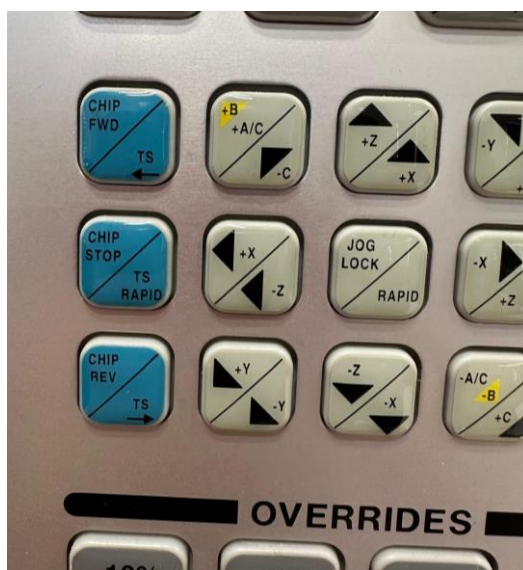
Slika 44. Tipke za pomicanje alata u određenom smjeru
