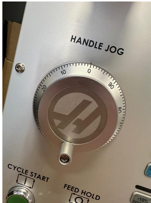
Slika 45. Kotačić za ručno pomicanje
