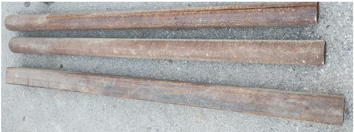
Slika 7.2. Osovina rotora i greda okvira
