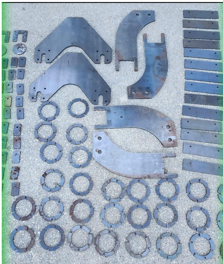
Slika 7.3. Dio elemenata rezanih „fiber“ laserom
