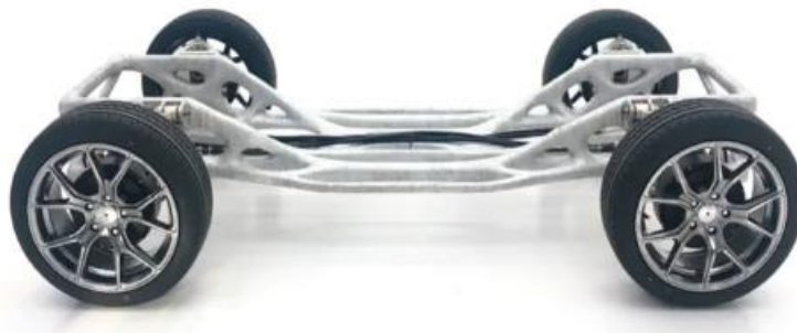
Slika 15 Šasija električnog automobila izrađena WAAM-om [22]
