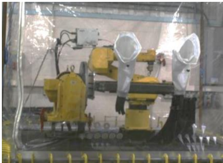
Slika 11 Šator za zaštitu [9]
