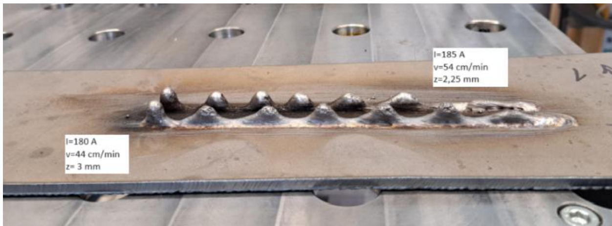
Slika 43 Drugi sloj navara u PE položaju
