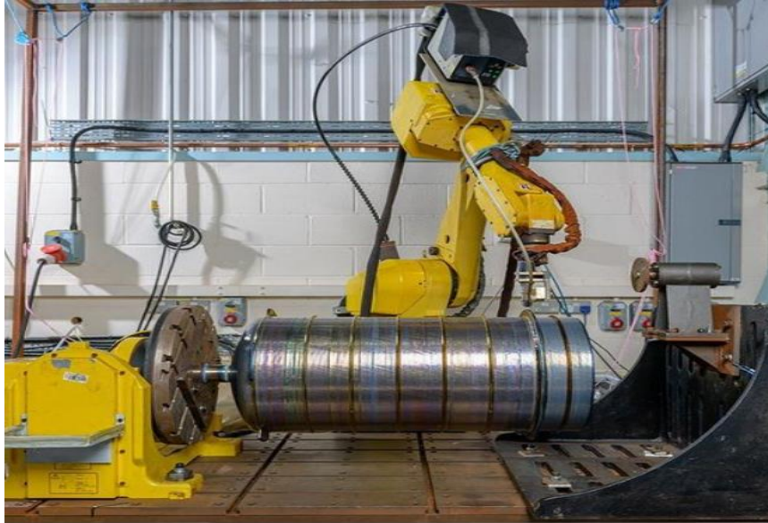
Slika 17 Izrada tlačne posude WAAM postupkom [25]
