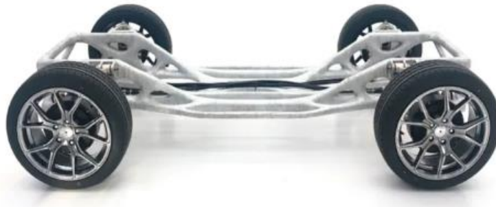
Slika 15 Šasija električnog automobila izrađena WAAM-om [22]
