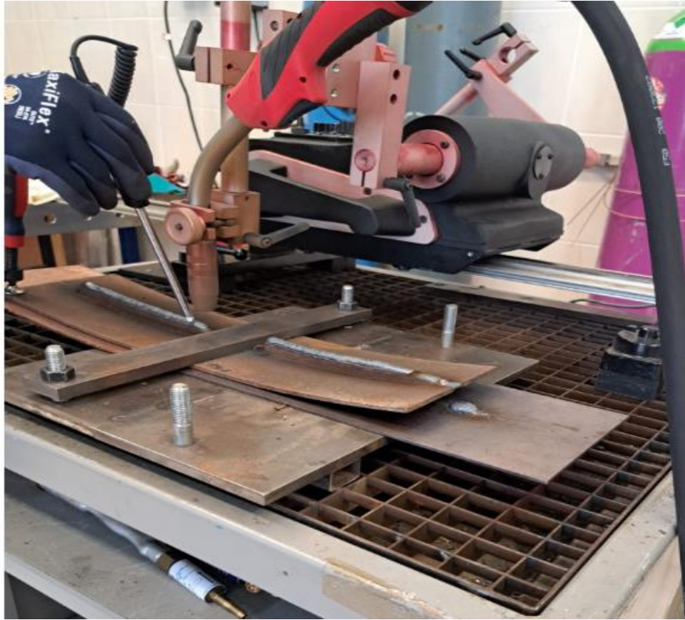
Slika 34 Savijanje podloge za navarivanje
