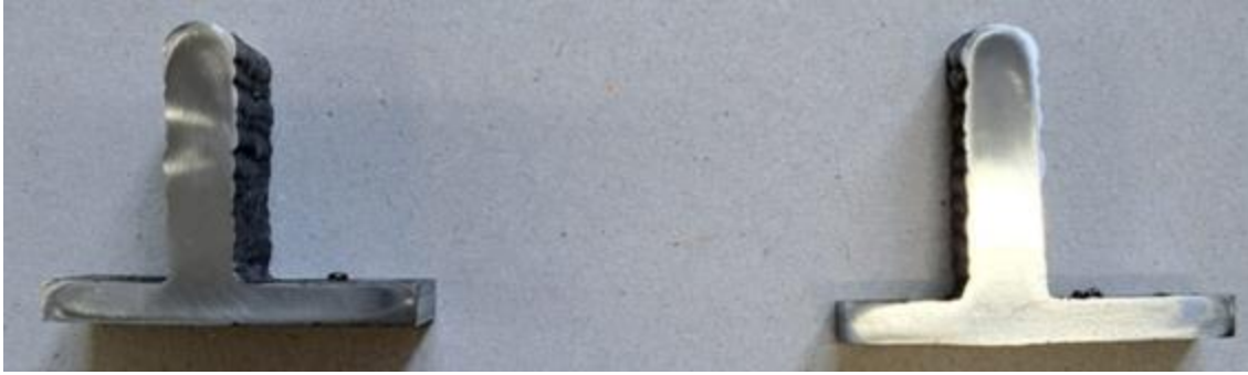
Slika 49 Površina uzorka nakon obrade brušenja navarenog strujom jakosti 180 A (lijevo) i 190 A (desno)
