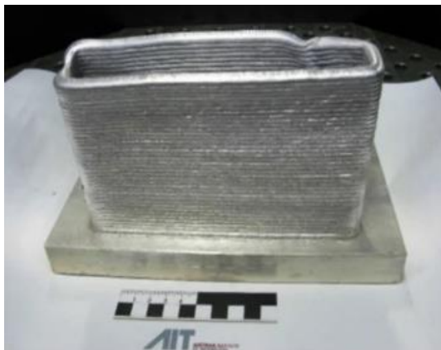
Slika 12 Uzorak magnezijeve legure izradene WAAM-om [16]
