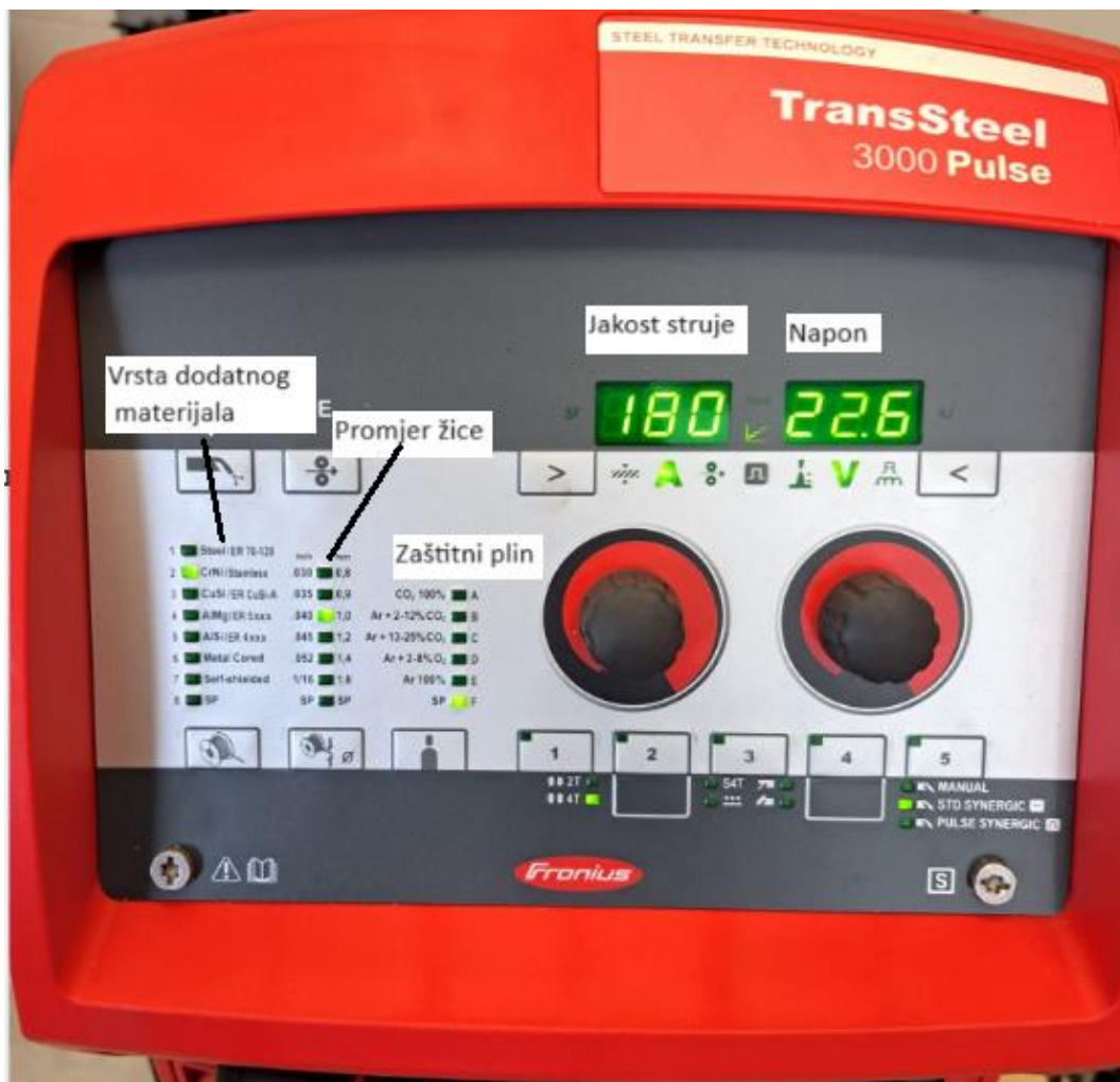
Slika 28 Upravljačka ploča uređaja za izvor struje za zavarivanje
