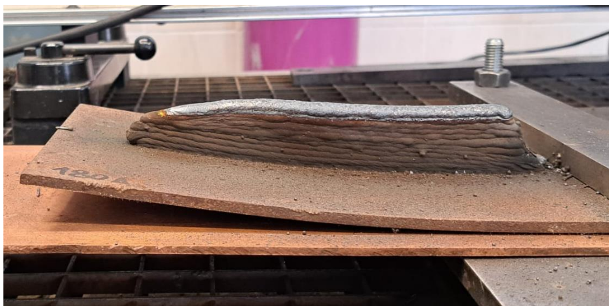
Slika 35 Zid navaren strujom jakosti 180 A
