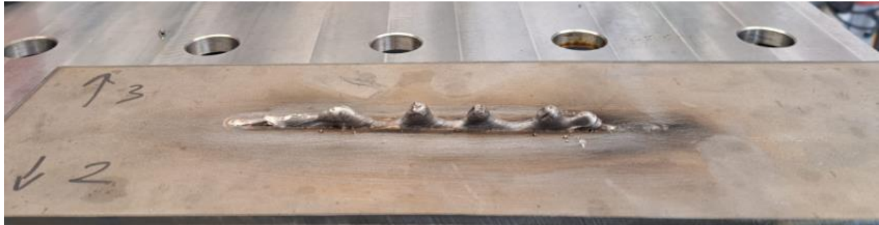
Slika 40 Drugi sloj navara u PE položaju ( I=180 A; v=36 cm/min; z=4,5 mm)
