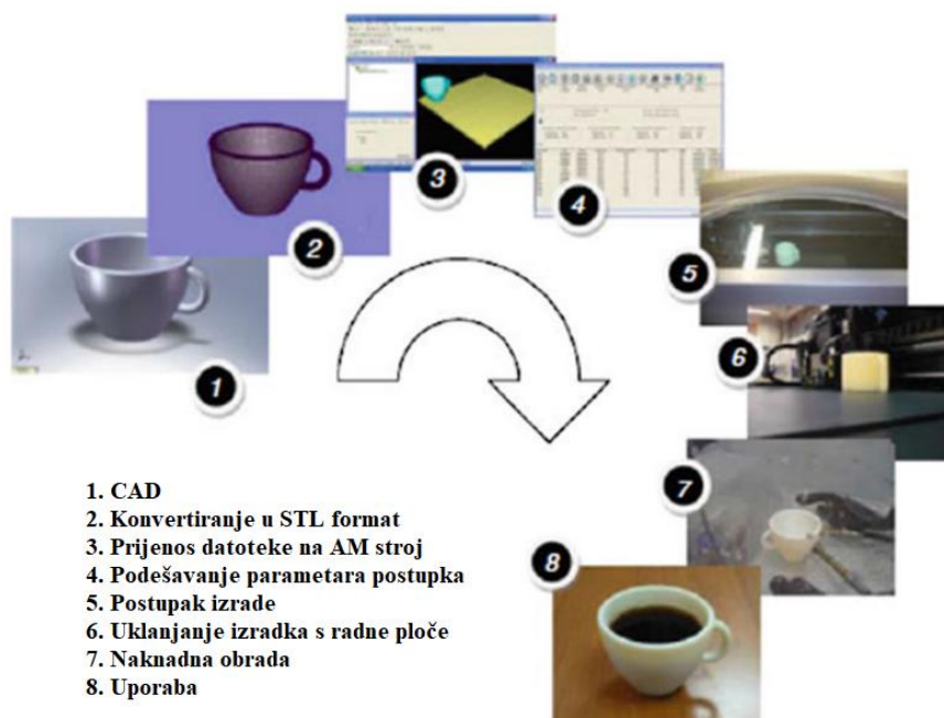
Slika 2.3 Koraci aditivne proizvodnje [1]
