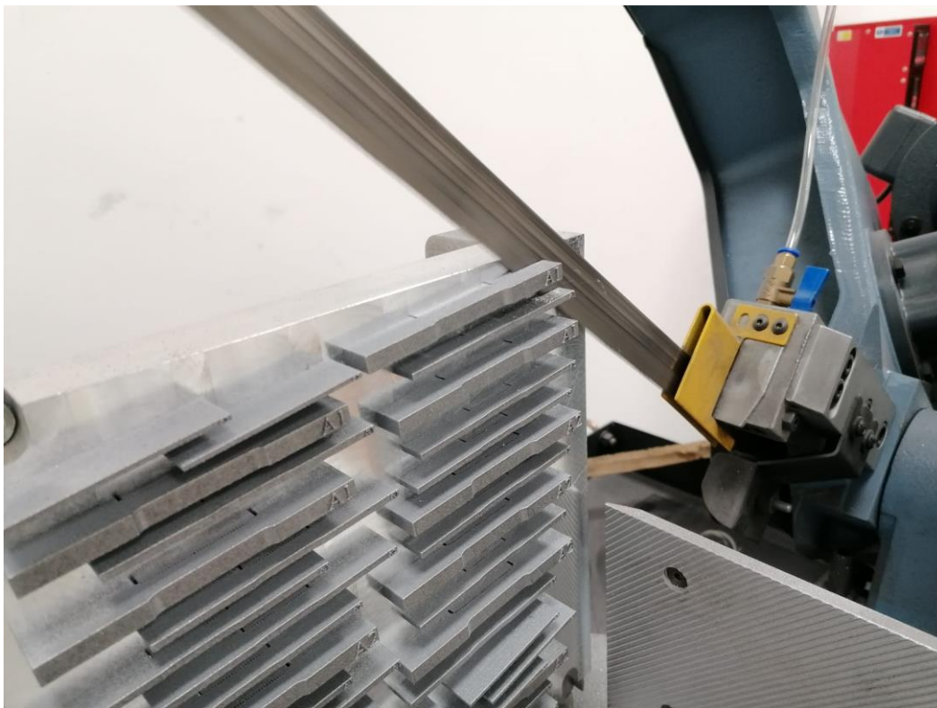
Slika 6.20 Odvajanje uzoraka s ploče
