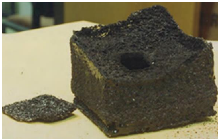
Slika 3.1 Prvi primjerak proizveden od ABS materijala postupkom s komorom praha (engl. Powder bed) [3]
