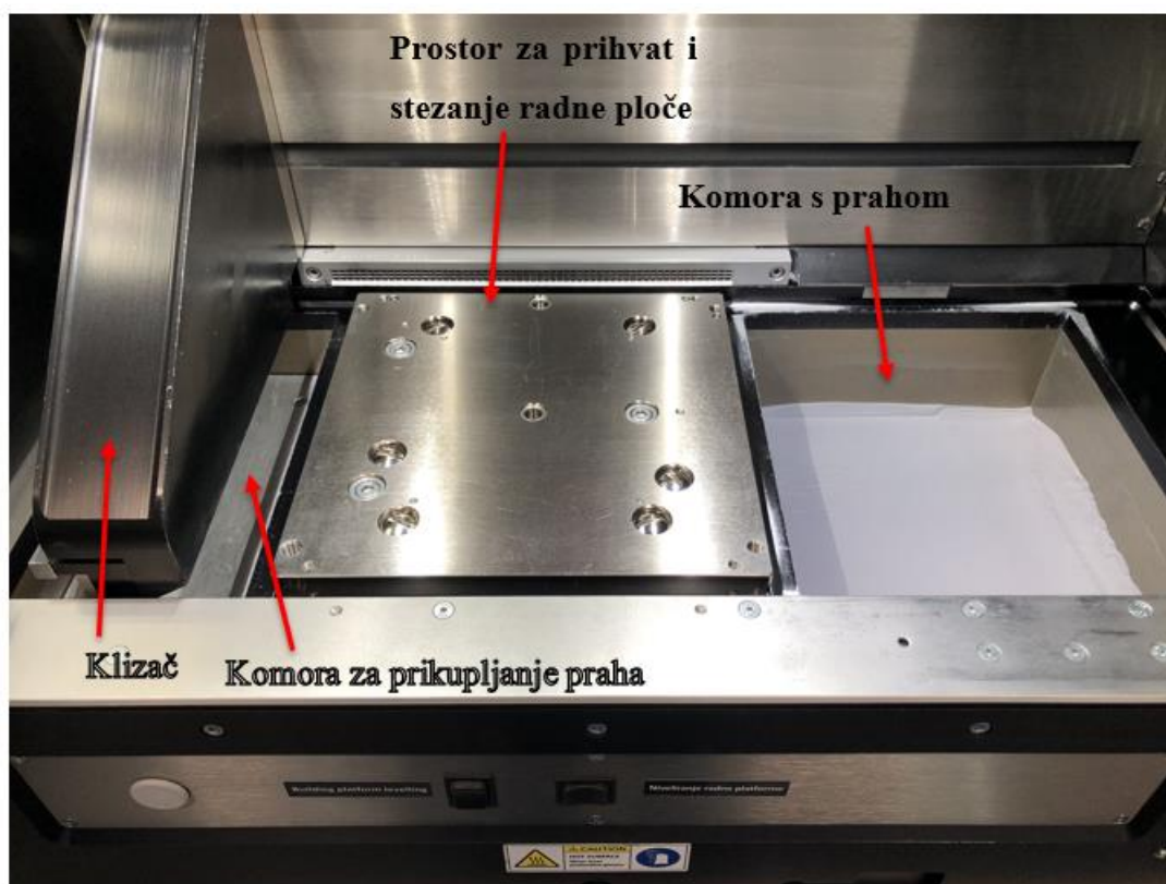
Slika 6.4 Radna komora EOS M 290
