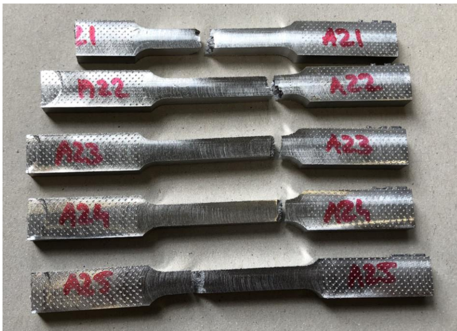
Slika 6.27 A2 epruvete nakon ispitivanja
