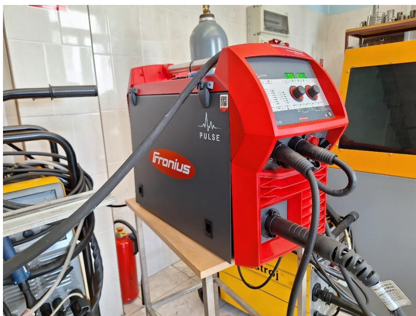
Slika 32 – Izvor struje za navarivanje Fronius TransSteel 3000 Pulse
