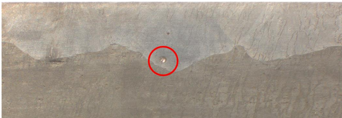
Slika 60 – Pogreška na četvrtom prolazu navarenog sloja (označena crvenom bojom)
