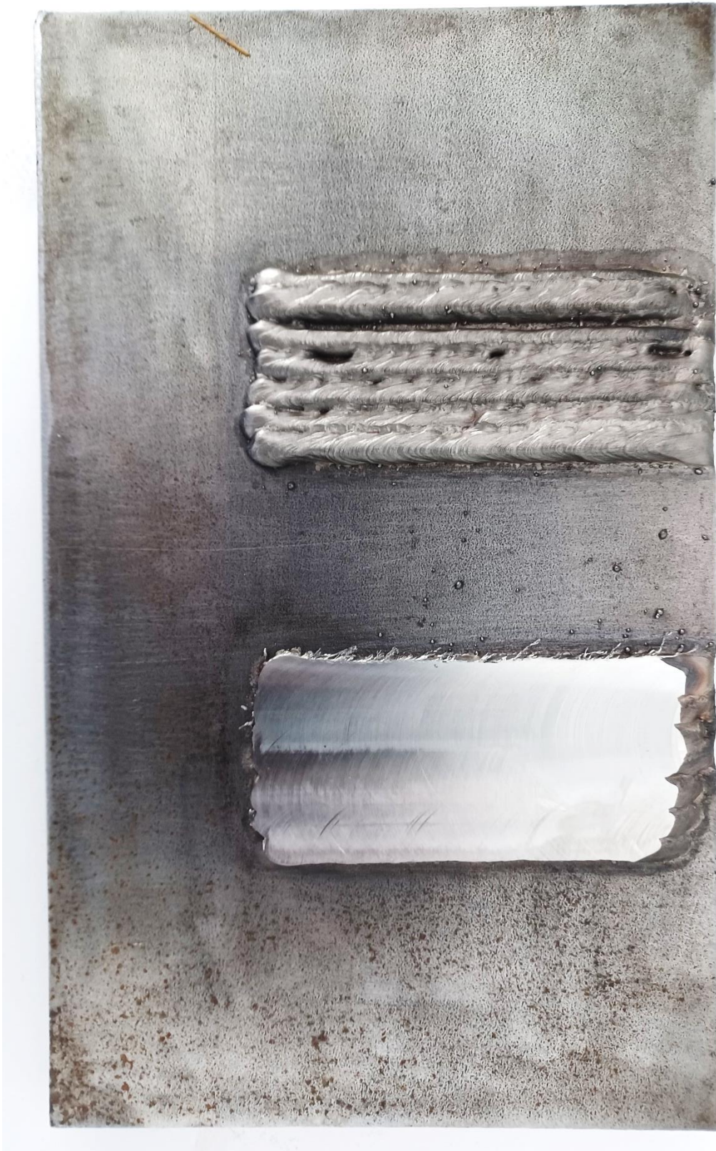
Slika 51 – OM s obrađenim navarenim slojem nehrđajućeg čelika prije izrezivanja uzoraka na strojnoj tračnoj pili
