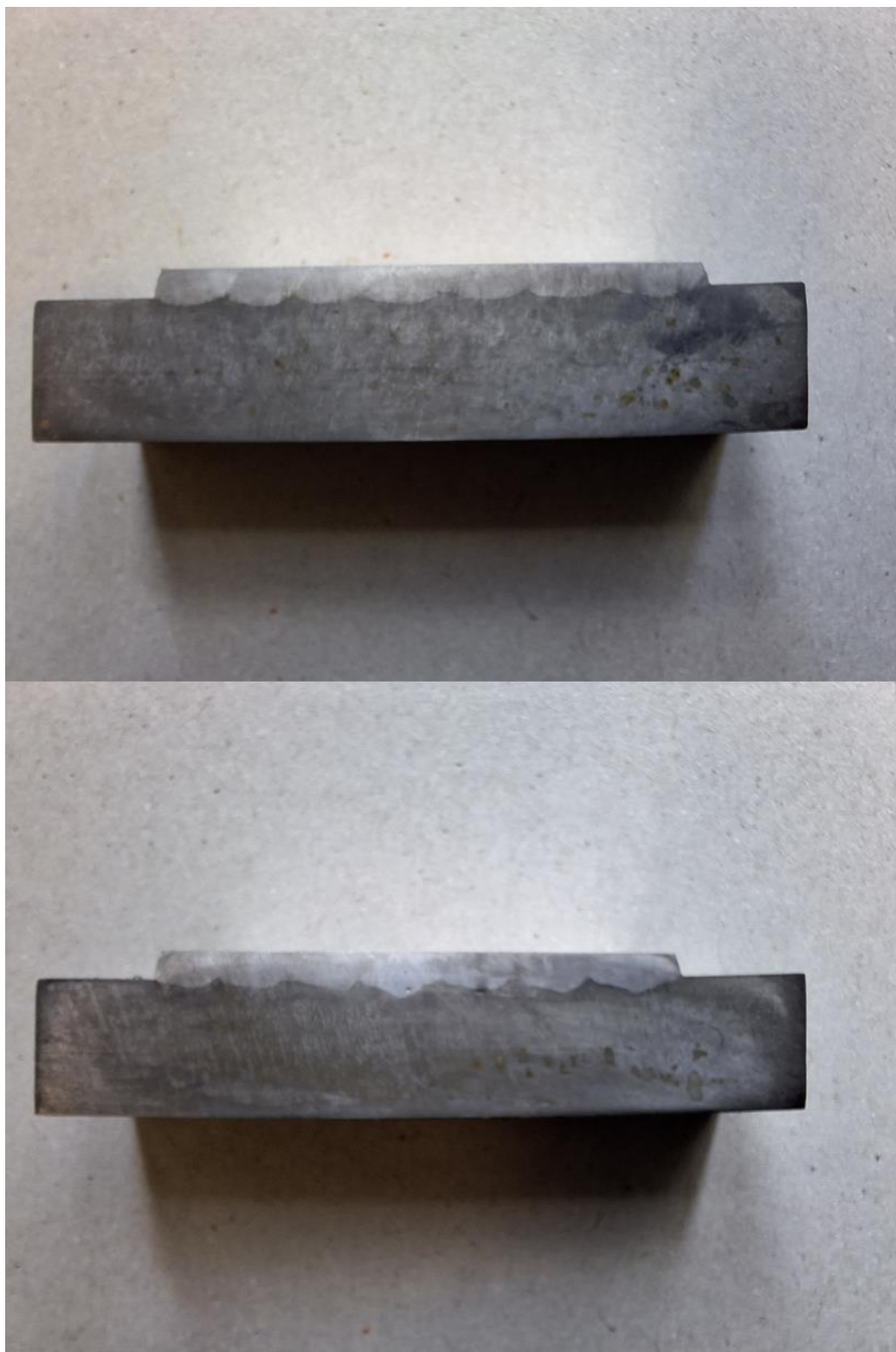
Slika 54 – Uzorci spremni za ispitivanje makrostrukture, prvi uzorak (gore) i drugi uzorak (dolje)
