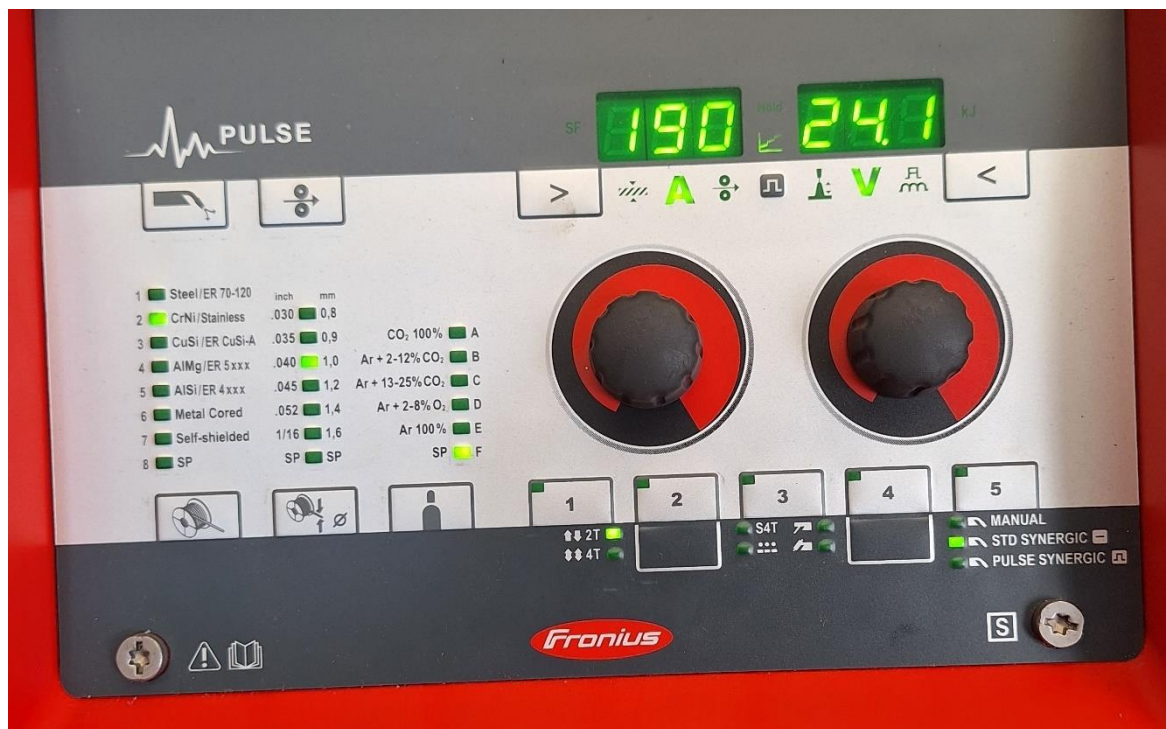
Slika 42 – Definirani parametri navarivanja u sustavu izvora struje za navarivanje
