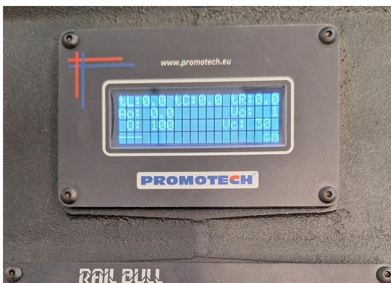
Slika 44 – Brzina navarivanja i pozicija navarivanja prvog prolaza uneseni u automat za precizno vođenje pištolja Promotech Rail Bull
