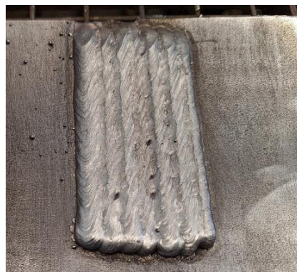
Slika 15 – Usporedni prolazi s kontinuiranim preklapanjem
