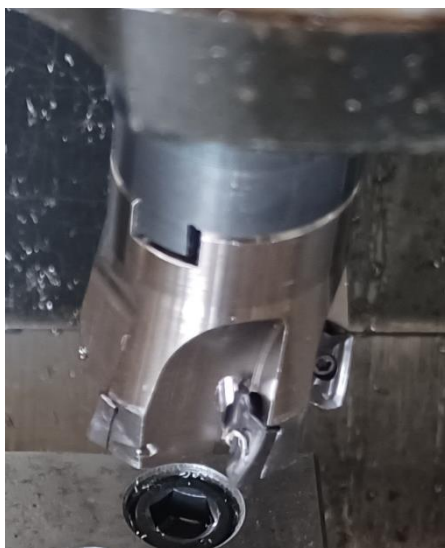
Slika 36 – Glodalo s izmjenjivim trokutnim pločicama ISCAR HM390 -10 promjera 40 mm
