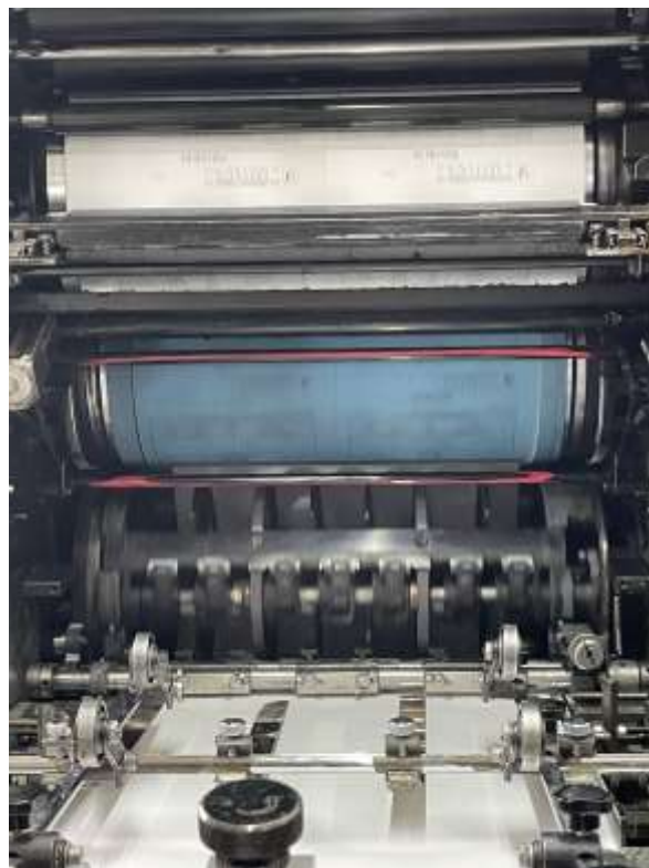
Slika 22. Temeljni valjak s tiskovno pločom (gore) te ofsetni valjak (dolje)
