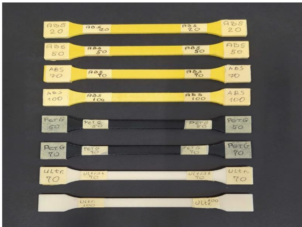
Slika 9.9. Ispitne epruvete za statičko vlačni pokus
