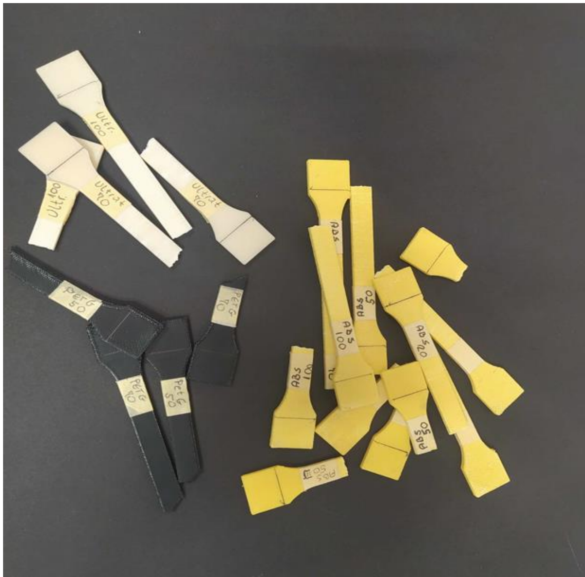
Slika 9.18. Epruvete nakon pokusa
