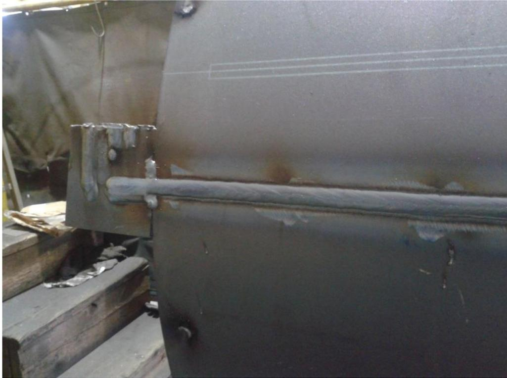
*Slika 6.3 Zavarivanje plašta s vanjske strane[9]*
