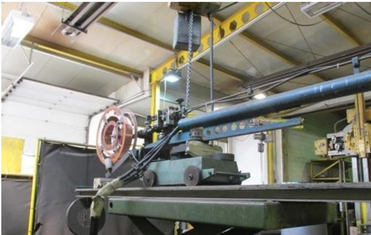
*Slika 6.6 Vodenje žice za EPP zavarivanje[9]*
