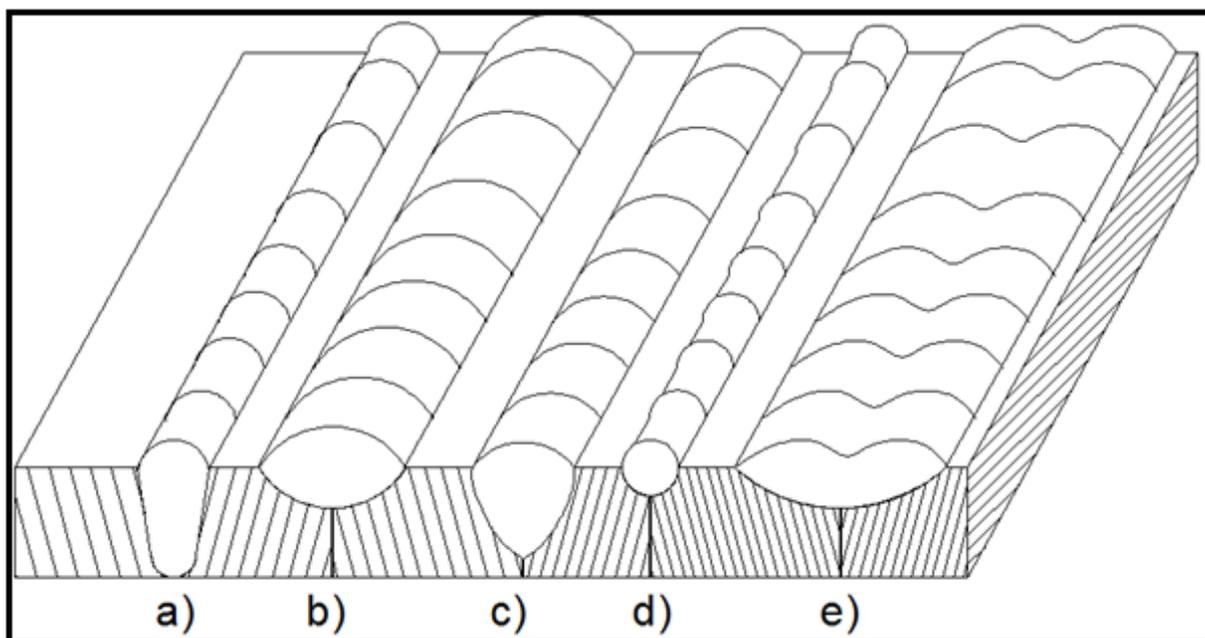
*Slika 3.1 Približan izgled zavora kod pojedinih parametara zavarivanja: a) prevelika jakost struje ili premali napon luka; b) preveliki napon luka; c) ispravno izvedeni zavar; d) prevelika brzina zavarivanja; e) premala brzina zavarivanja*
