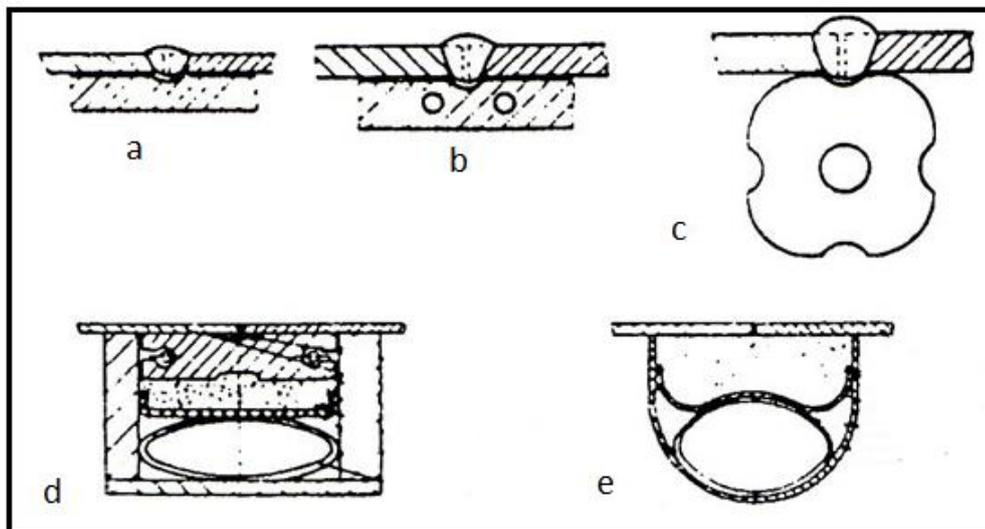
*Slika 3.2 Najčešće primjenjivi tipovi podloga za EPP zavarivanje: a) bakrena podloga u obliku bakrene letve; b) i c) bakrene podloge hladene vodom; d) kombinirana bakrena podloga s praškom; e) podloga praška*
