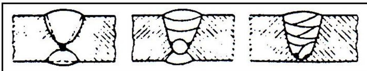
Slika 5.4 Izgled uključaka troske u zavarenom spoju[7]
