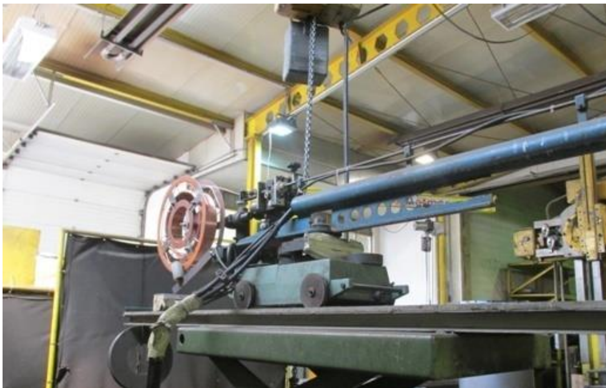
Slika 6.6 Vodenje žice za EPP zavarivanje[9]
