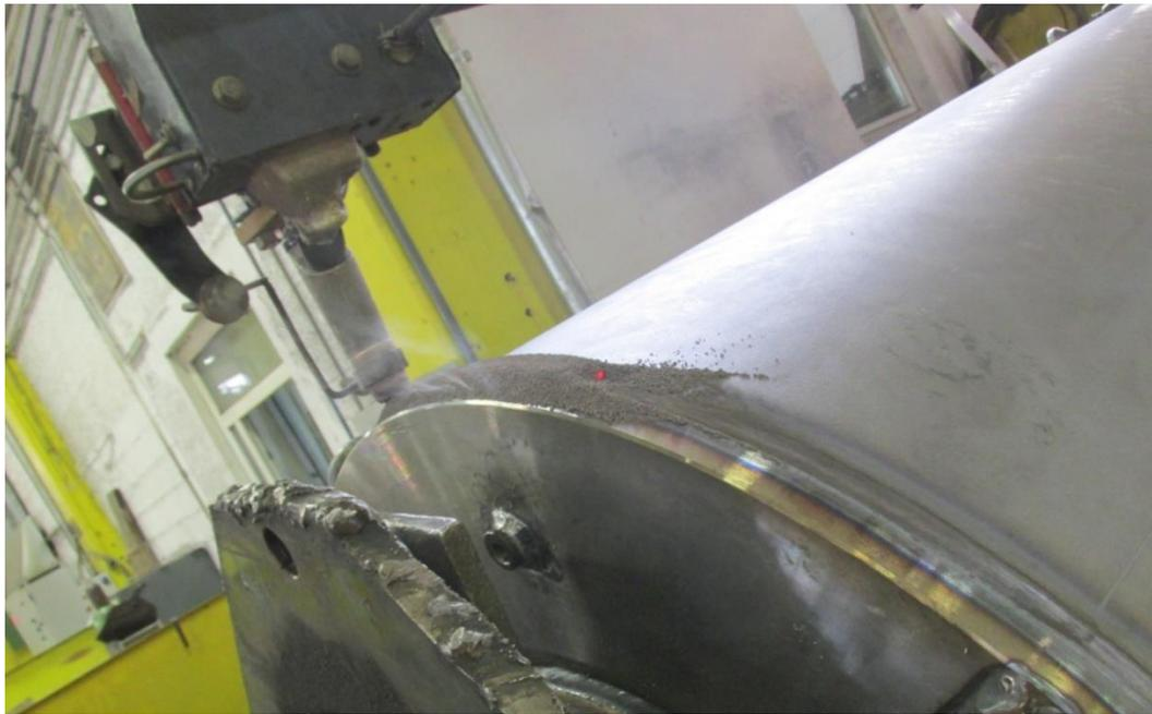
*Slika 6.7 Izgled zavarenog spoja nakon zavarivanja[9]*
