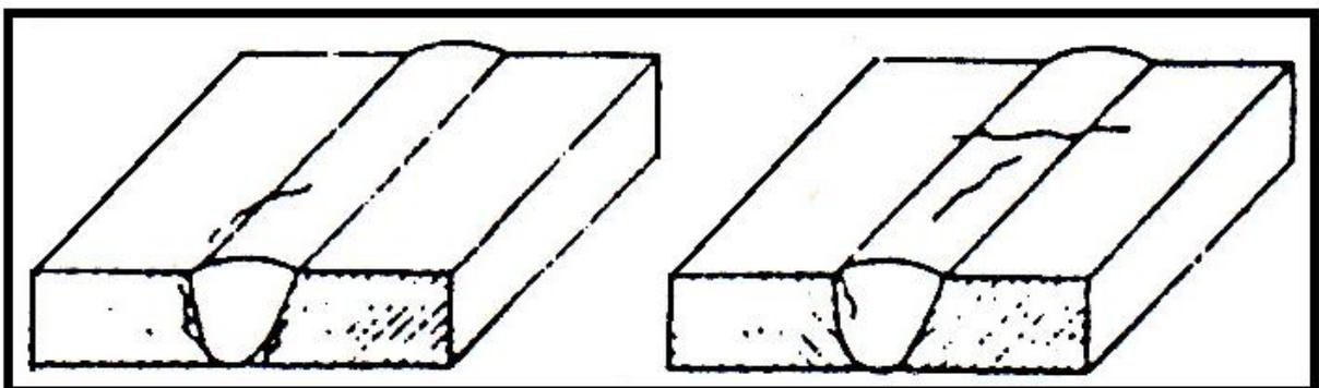
*Slika 5.7 Izgled hladnih pukotina u zavarenom spoju[7]*
