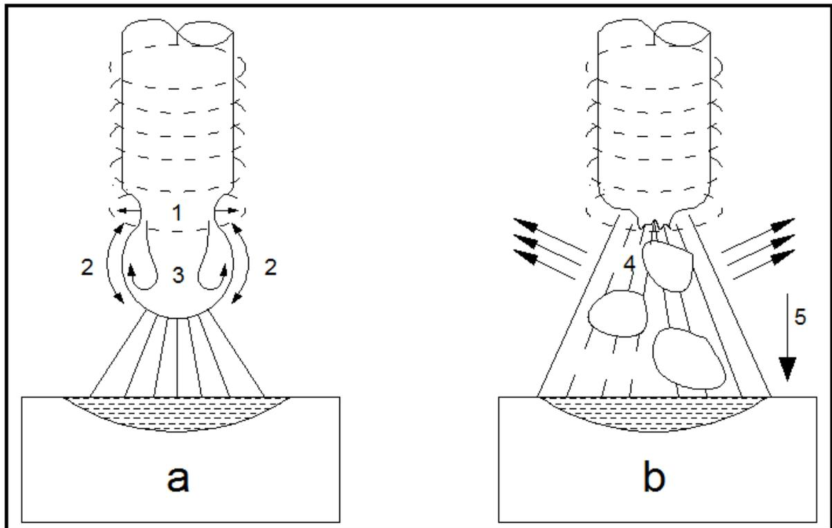
*Slika 2.7 Prijelaz kapljica u električnom luku kod EPP zavarivanja a) uspostavljeni električni luk: djelovanje sile na formiranje kapljice: 1- elektromagnetska sila, 2-sila površinske napetosti, 3- viskozitet, žitkost kapljice metala. b) odvajanje kapljice metala uz djelovanje sile: 4 – sile strujanja plinova, 5 – gravitacija[7]*
