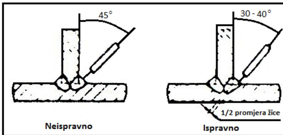
Slika 3.5 Nagib žice prilikom zavarivanja kutnog zavara[7]
