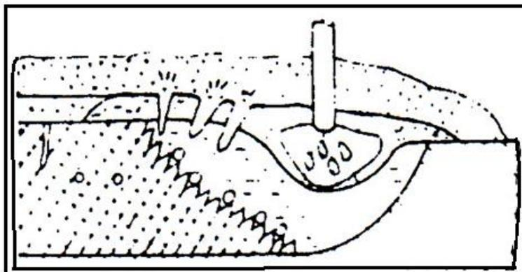
Slika 5.1 Prikaz nastajanja pora u zavarenom spoju[7]
