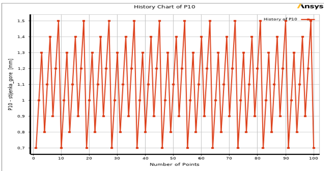
Slika 4.8 Optimizacija – promjena vrijednosti debljine stijenke prečke
